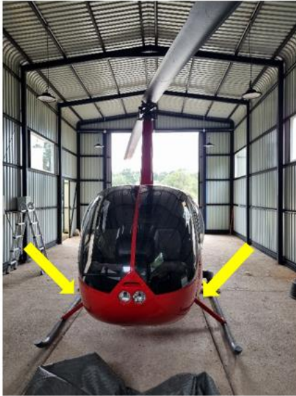
Fotografía N°2 y 3: Patines deformados y estabilizador vertical deformado
