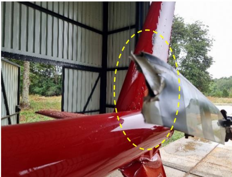
Fotografía N°4 y 5: Pala rotor de cola deformada y estabilizador vertical deformado
