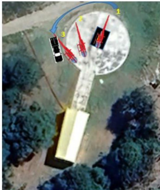
Fotografía N°16: Recreación helicóptero Robinson R44 II, impacto con la camioneta.
