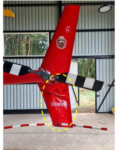
Fotografía N°4 y 5: Pala rotor de cola deformada y estabilizador vertical deformado
