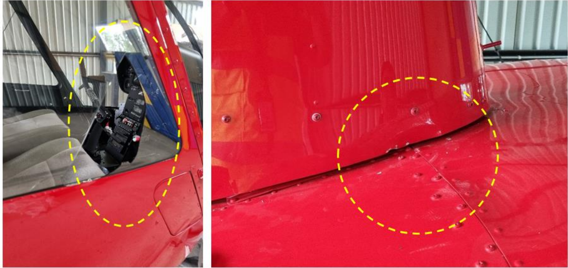
Fotografía N°6 y 7: Fractura parabrisas y estabilizador vertical deformado
