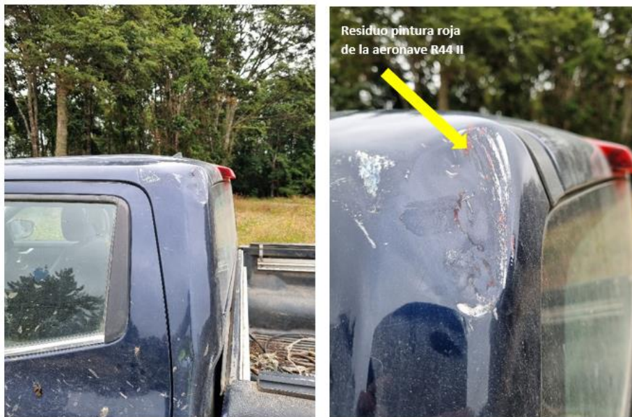
Fotografía N°8 y 9: Daño producto del impacto en Vehículo de Trabajo.
