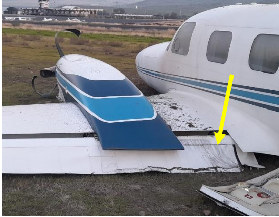
Fotografías N° 10 y 11: Vistas de los daños de ambos flaps.
