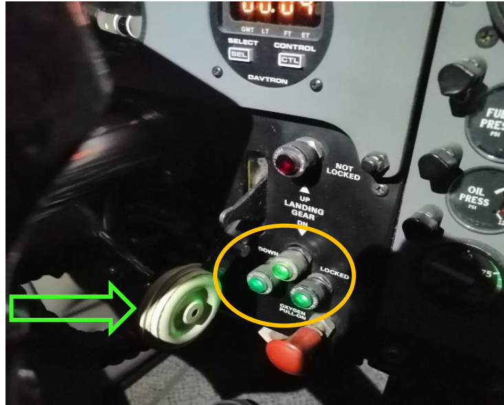
Fotografía N° 22: Vista de la palanca de bajada de tren (flecha verde) y del indicador de tren de aterrizaje abajo y asegurado, con las 3 luces verde encendidas (círculo naranja).
