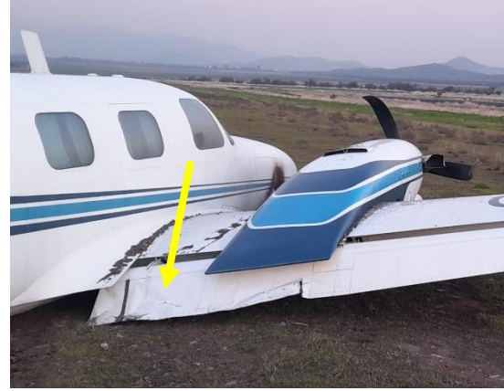
Fotografías N° 10 y 11: Vistas de los daños de ambos flaps.
