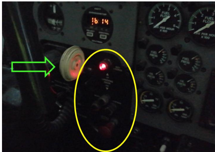
Fotografía N°23: Vista de la palanca del tren de aterrizaje (flecha verde) en posición arriba y de la luz de recorrido encendida (luz roja).
