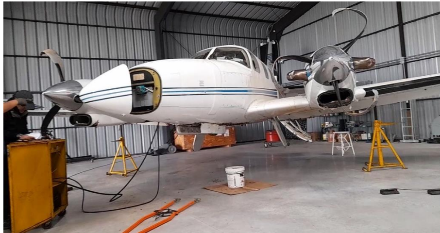
Fotografía N° 20: Vista de la aeronave con el tren de aterrizaje arriba retraído.
