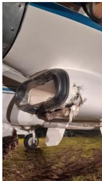
Fotografías N° 8 y 9: Vistas de los daños de los Engine Cowl de los motores.
