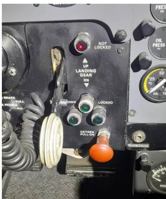
Fotografía N° 16: Vista de la palanca del tren de aterrizaje y luces de operación.
