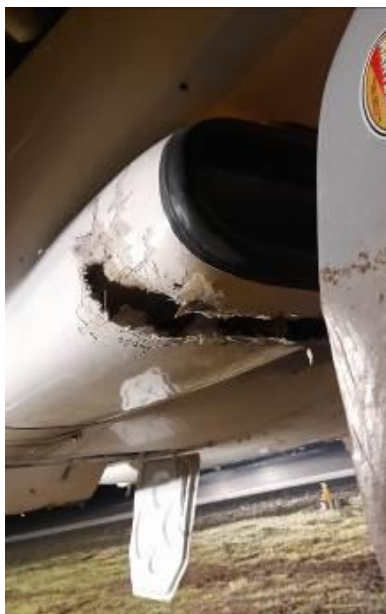
Fotografías N° 8 y 9: Vistas de los daños de los Engine Cowl de los motores.
