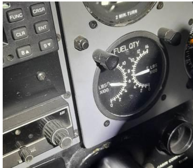
Fotografía N° 17: Vista del indicador de combustible de la aeronave.
