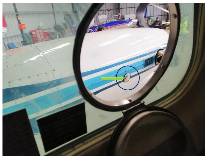
Fotografía N° 18: Vista del espejo desde la posición del piloto al mando, para verificación del tren de nariz (flecha verde).
