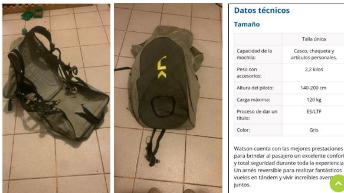
Fotografía N°17 y 18: Conjunto de silla y arnés de seguridad del pasajero.
