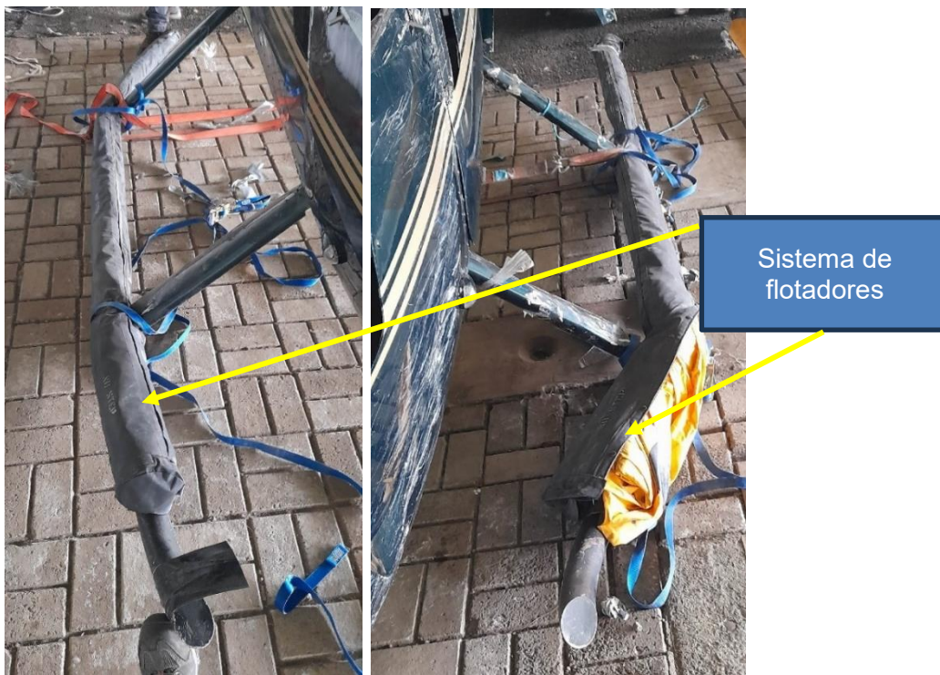
Fotografías N°23 y 24: Vistas del tren de aterrizaje y sistema de flotación. Los bastones de vuelo cíclico y colectivo estaban sin daños (Fotografía N°25 y 26).
