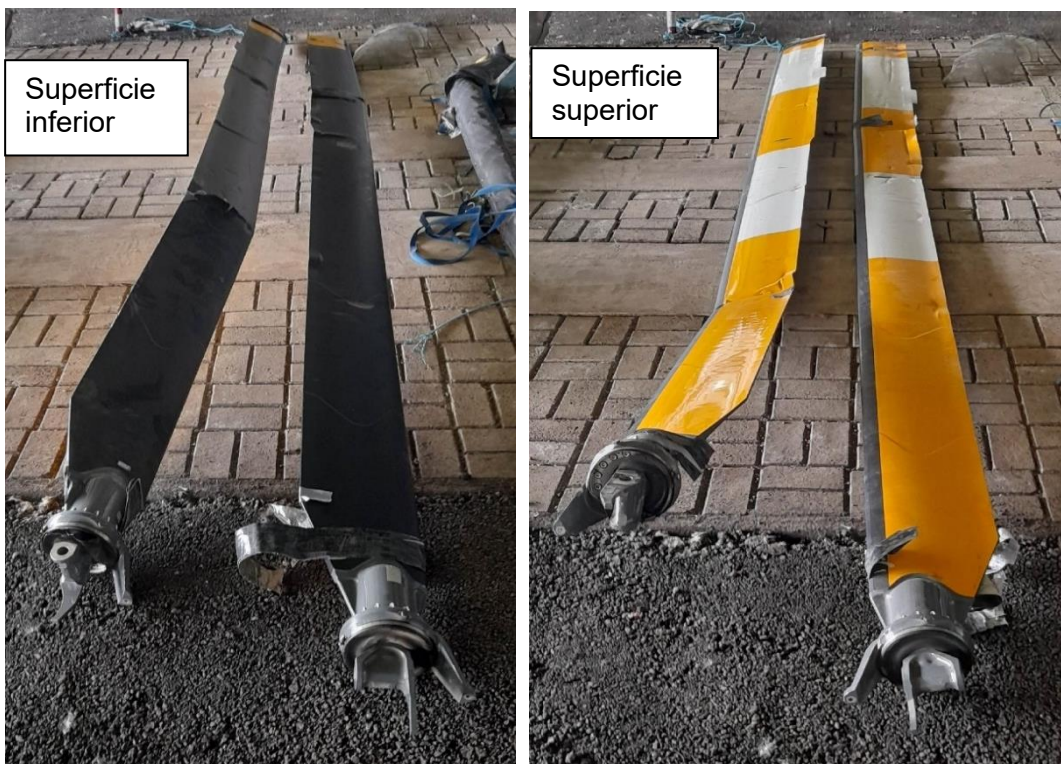
Fotografías N°16 y 17: Vistas de las palas del rotor principal.
