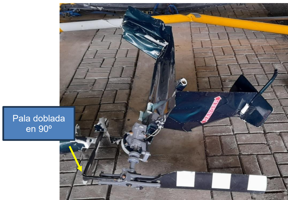
Fotografía N°19: Vista del rotor de cola.
