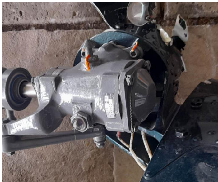
Fotografía N°20: Vista de la caja de cola.
