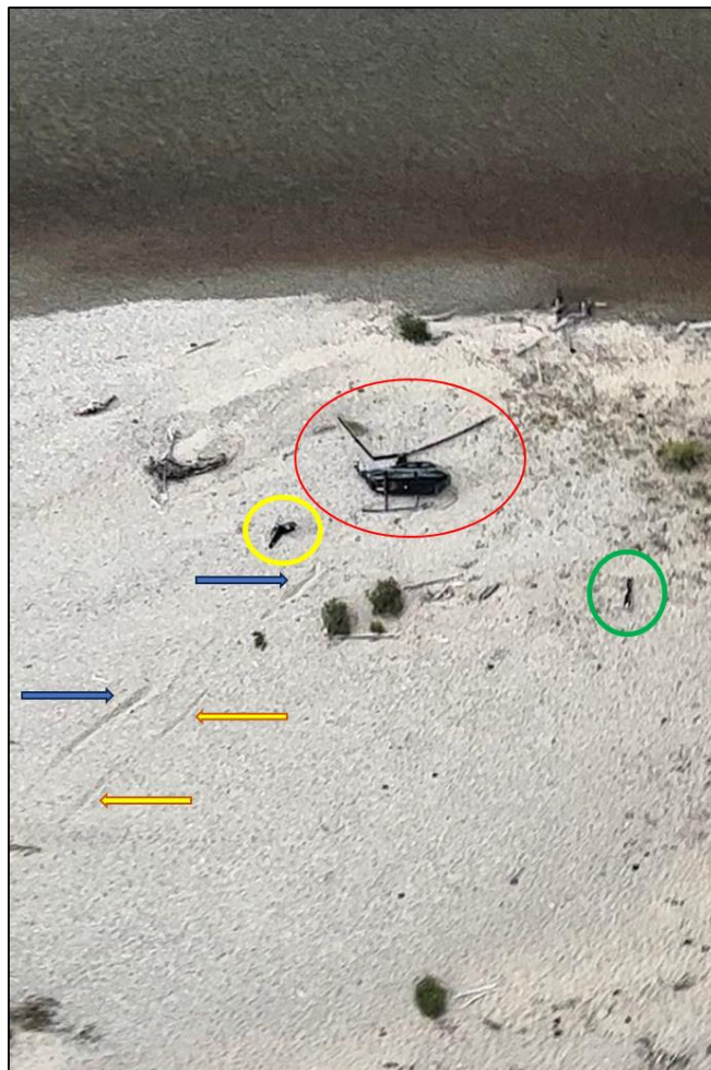
Fotografía N°4: Vista de las huellas de arrastre, ubicación final de la aeronave y parte de sus componentes.
