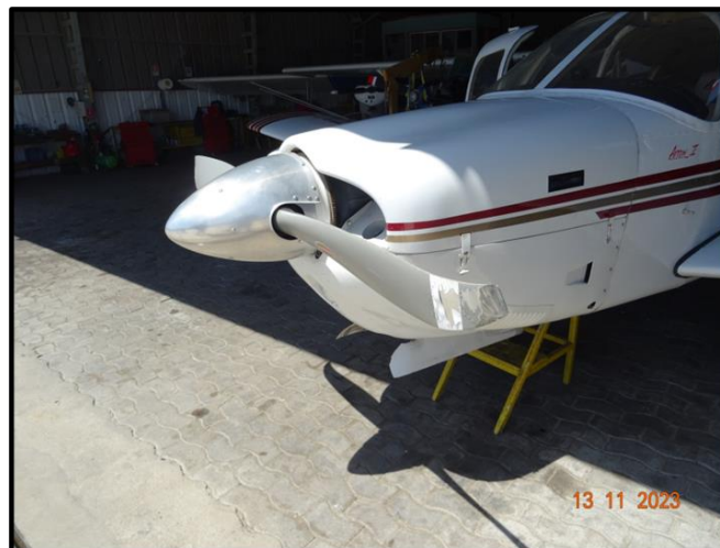
Imagen N°5: Daños en las palas de la hélice
