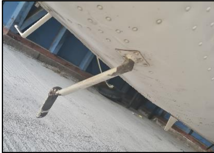
Fotografía N°11: Pisadera lado izquierdo deformada.
