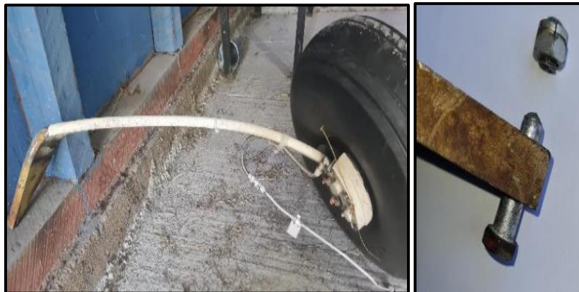
Fotografías N° 9 y 10: Tren de aterrizaje principal izquierdo y su perno de fijación.
