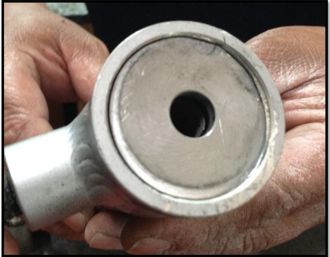
Fotografía N°10. Tapa de cilindro actuador de la pierna de nariz.
