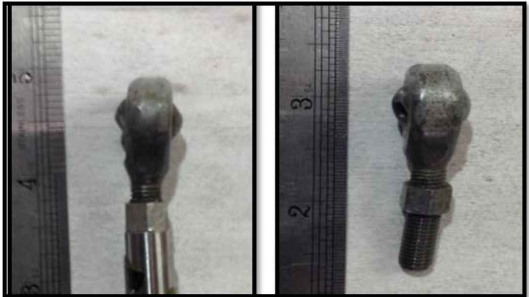
Fotografías N°11 y N°12. Vistas del terminal (rod end), deformado.
