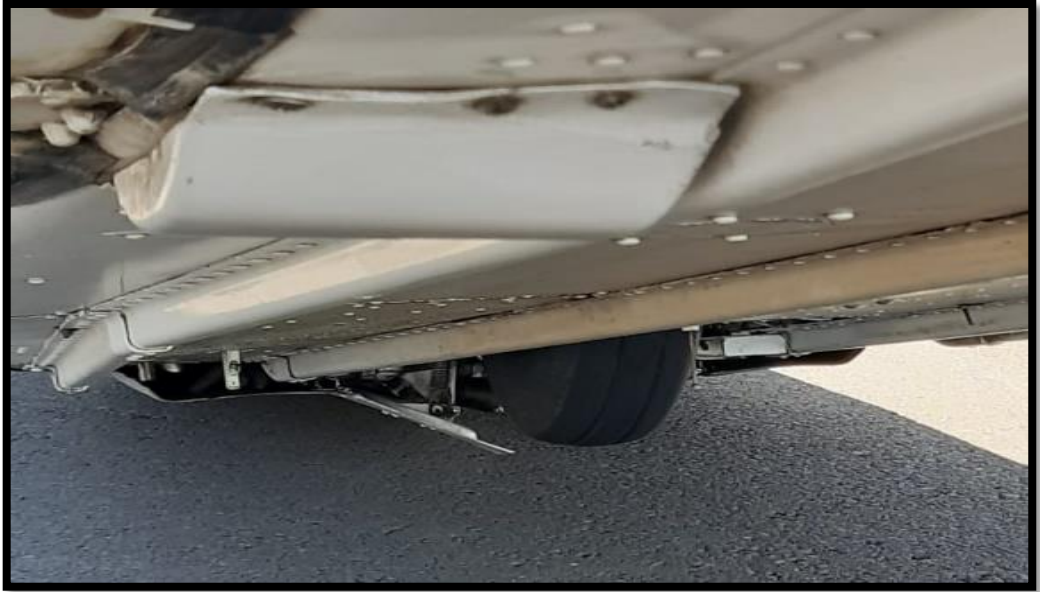
Fotografía N°4. Pierna de nariz del tren de aterrizaje, trabada o en recorrido
