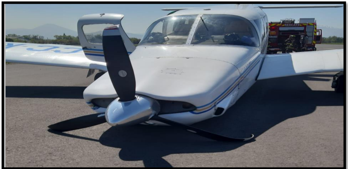
Fotografía N°5. Daños en las palas de la hélice.
