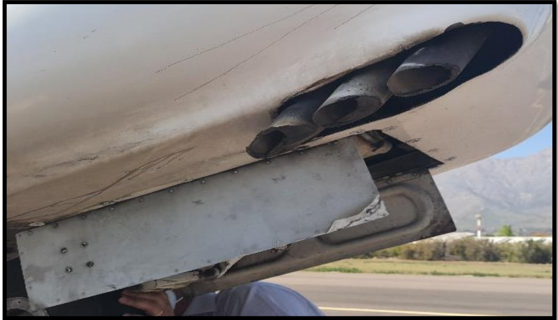
Fotografía N°6. Daños en portalones de pierna de nariz y tubos de escape.
