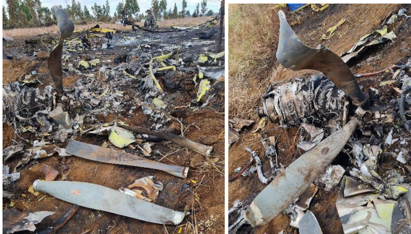
Fotografías N°10 y 11: Palas de la hélice y motor.
