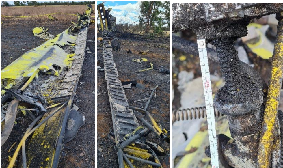
Fotografía N°5,6 y 7: Alas de la aeronave y tornillo sin fin de flaps.
