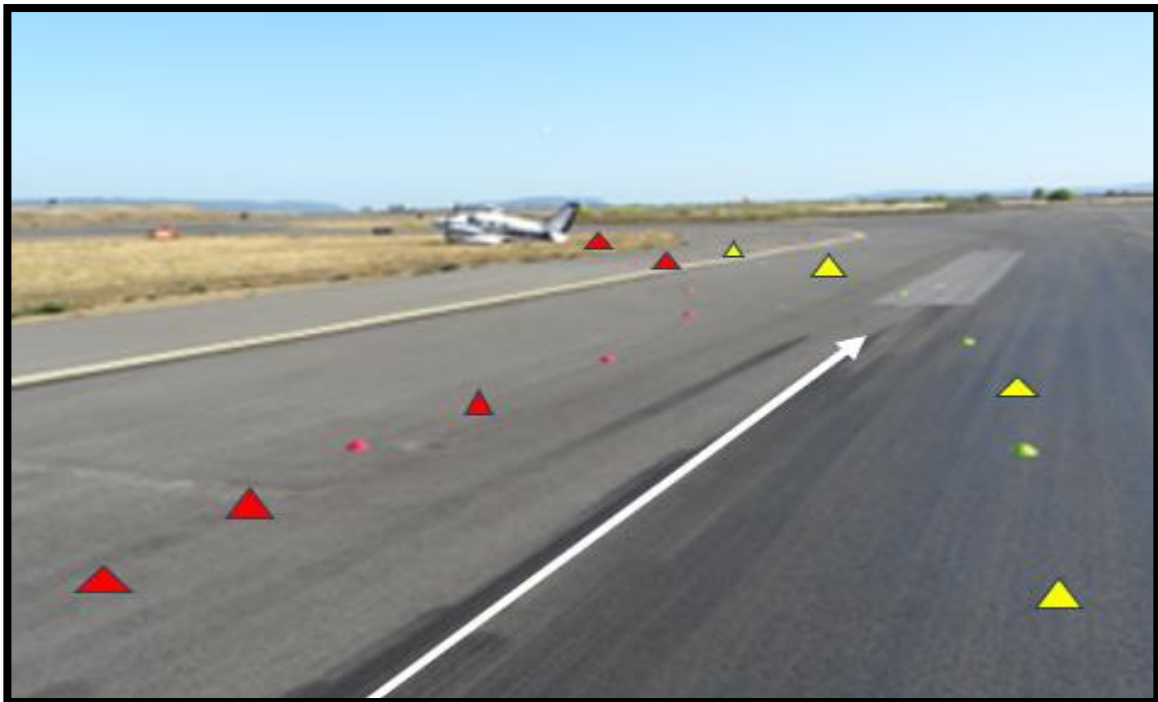
Fotografía N°3: “Las marcas de los neumáticos: izquierdo (rojo), derecho (amarillo)”
