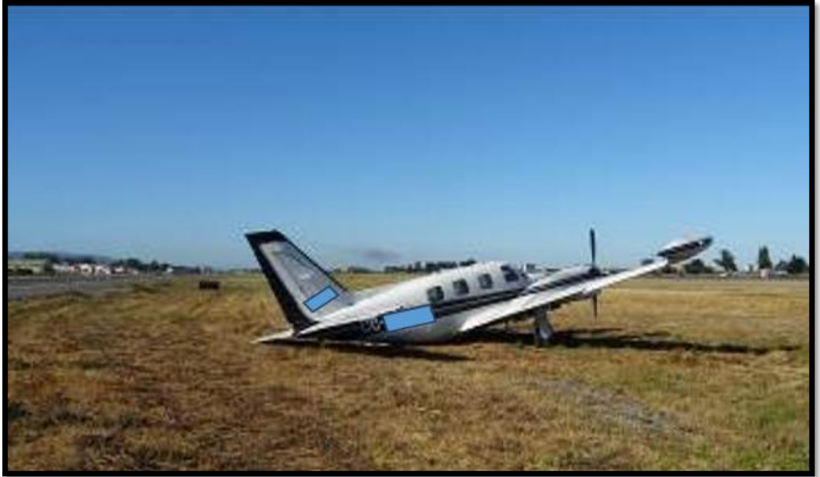
Fotografía N°4: "Aeronave apoyada en su ala izquierda en la posición final".
