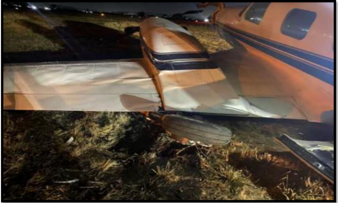
Fotografía N°2: “Daños en el tren principal izquierdo y ala izquierda”.
