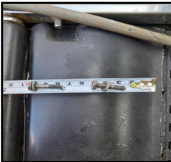
Fotografías N°13 "Pernos del sistema de dirección del tren de nariz"
