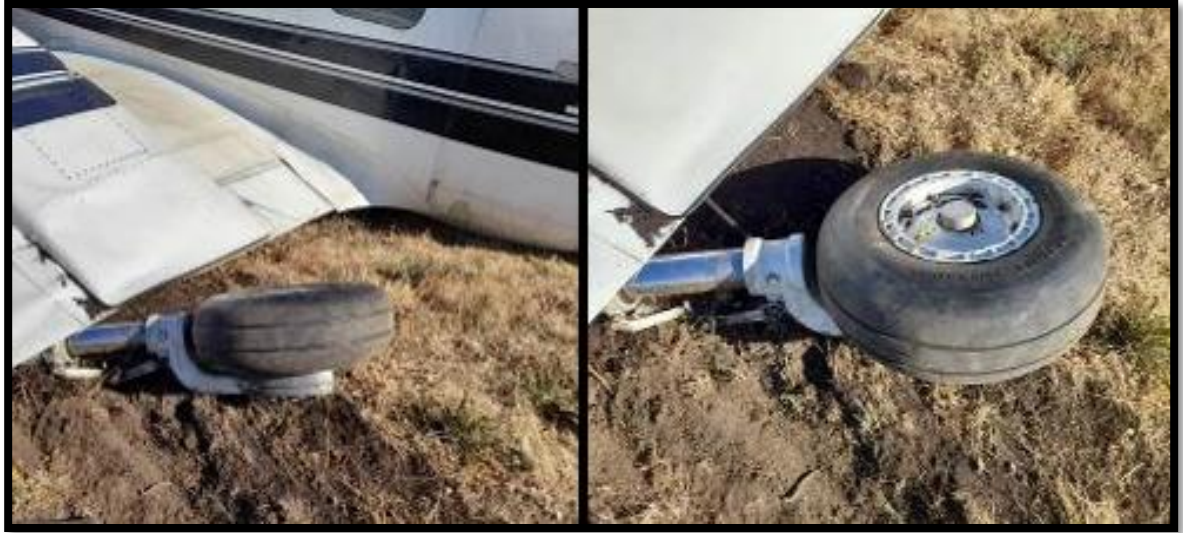
Fotografía N°6 A/B: "Vistas de la pierna izquierda del tren de aterrizaje".
