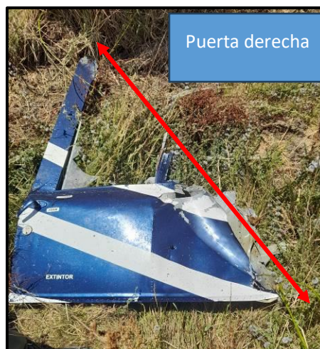
Fotografías N°9 y 10: Puerta izquierda y Puerta derecha de la cabina con corte longitudinal.
