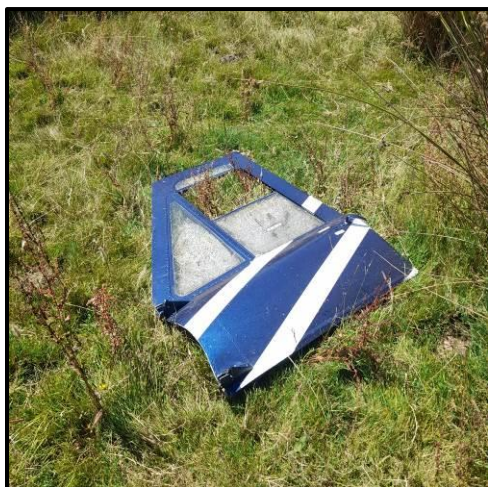
Fotografías N°9 y 10: Puerta izquierda y Puerta derecha de la cabina con corte longitudinal.
