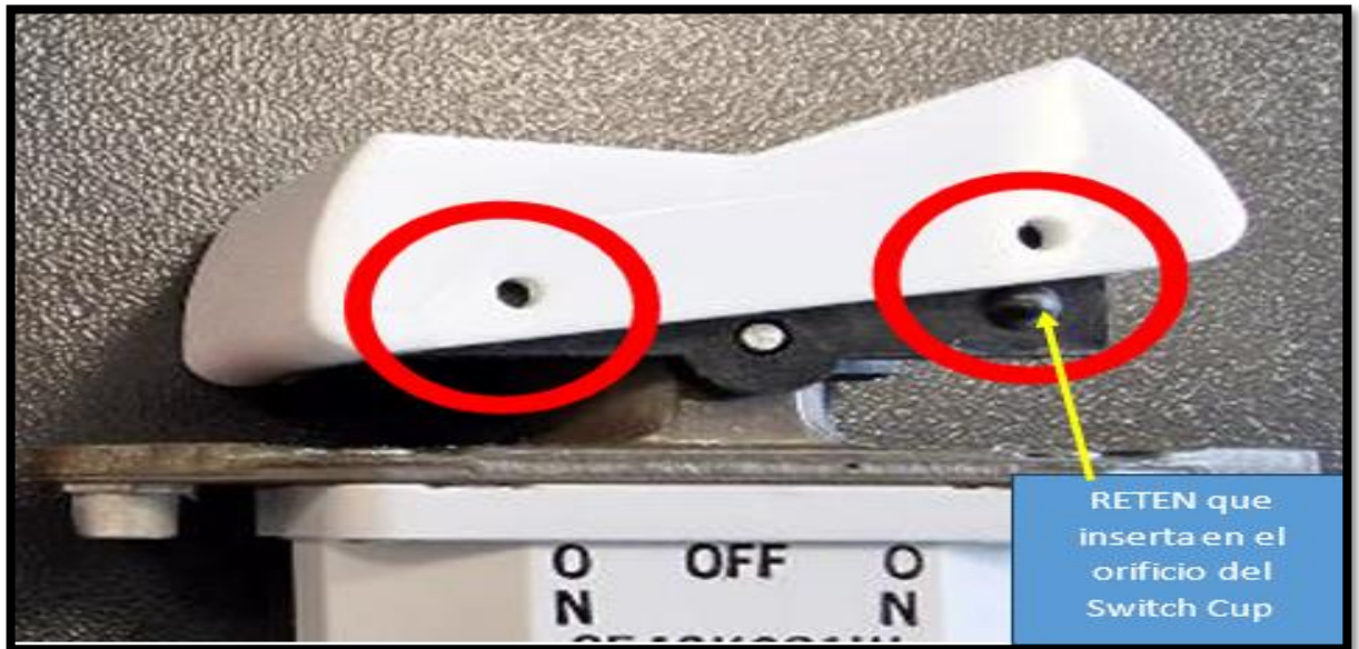
Fotografía N°20: Vistas del SWITCH CUP y sus puntos de fijación.
