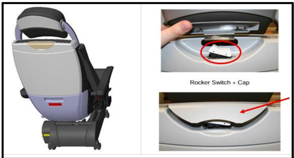
Fotografía N°13: Vista referencial de un asiento, con el SWITCH CAP suelto y el SWITCH COVER Levantado.
