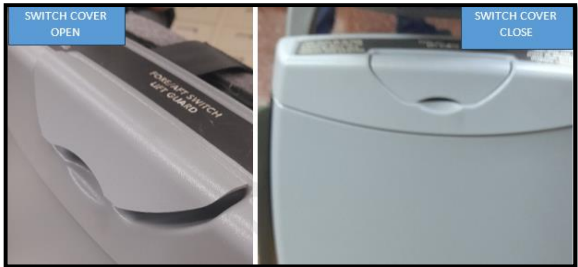
Fotografía N°15: Vistas del SWITCH COVER en las posiciones abierto y cerrado, posterior al suceso.
