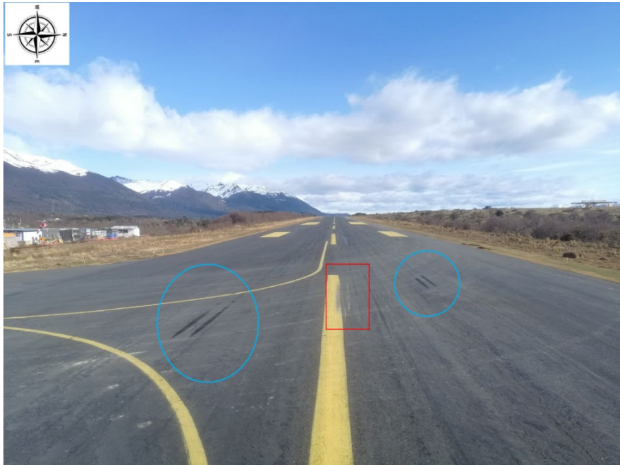
Fotografía N°4: Vista de las huellas del tren de aterrizaje (círculos celestes) y del tail strike (cuadro rojo).
