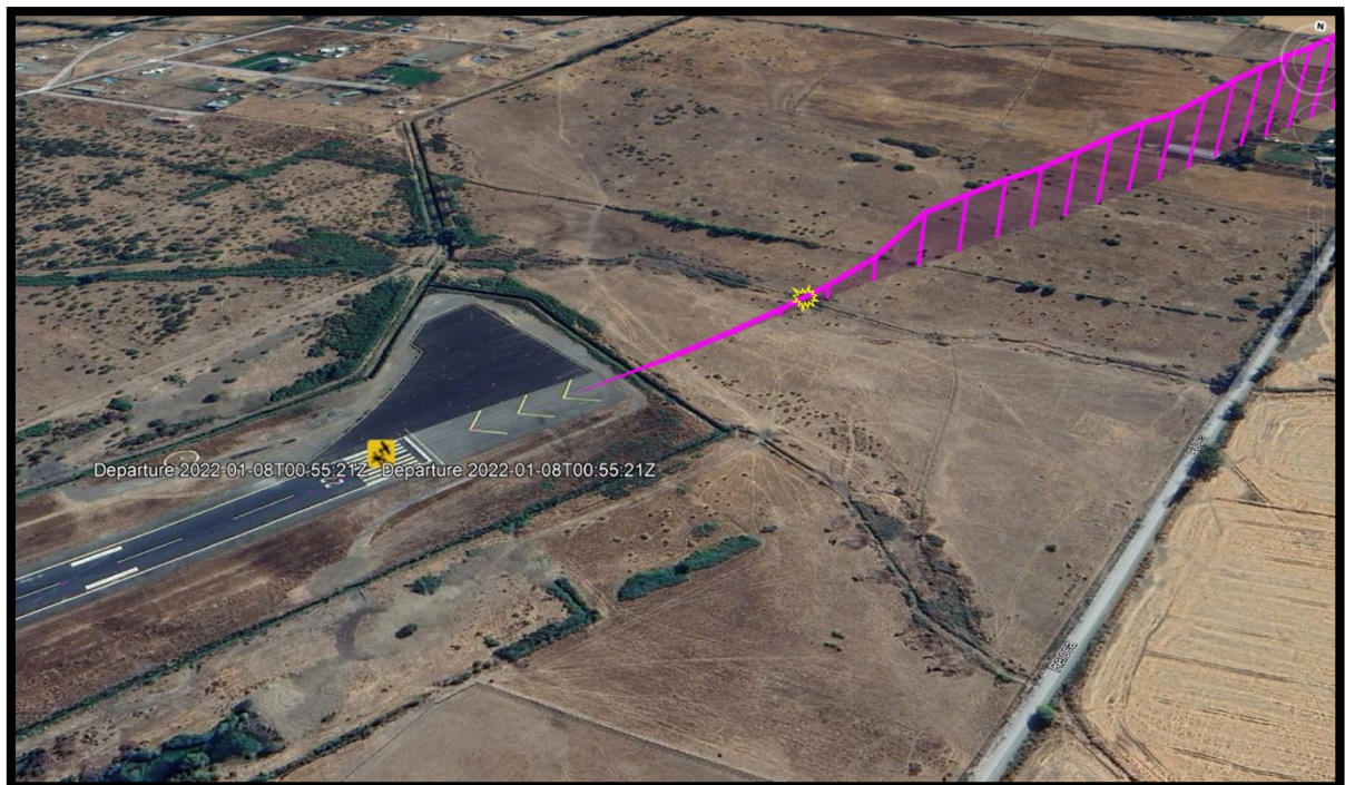
Imagen 03: Ampliación del registro de la aproximación a pista 22, del aumento de la razón de descenso y lugar del impacto (Marca amarilla).
