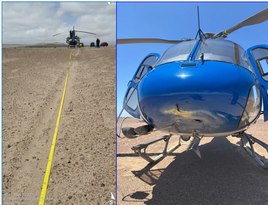
Vista de las huellas de los patines durante el aterrizaje con carrera y daños en la estructura delantera.
