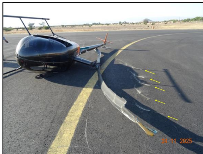
Imagen N°4: Marcas de las palas rotor principal
