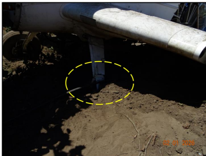
Imagen N°6: Desprendimiento de la rueda de la pierna izquierda
