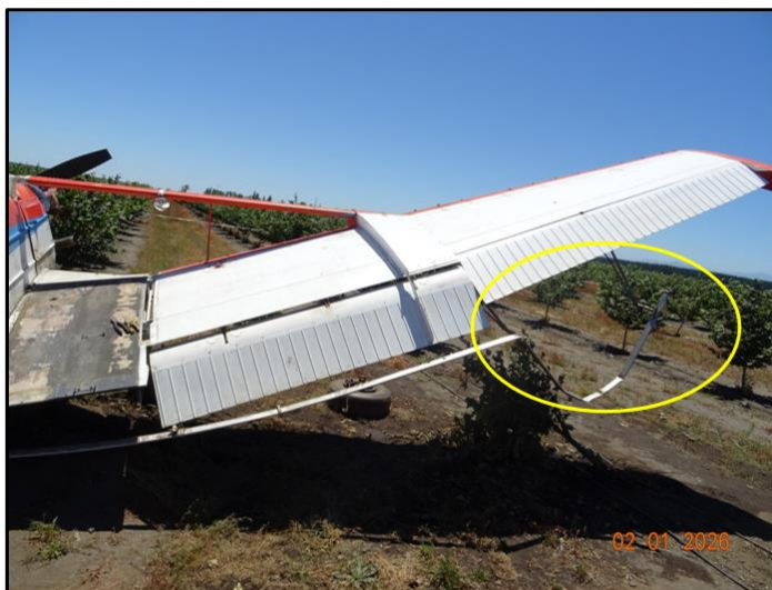
Imagen N°8: Daños en la barra de fumigación ala derecha
