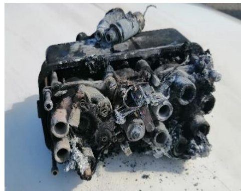
Fotografías 3 y 4: Daños en la capota superior y en el magneto tipo dual.
