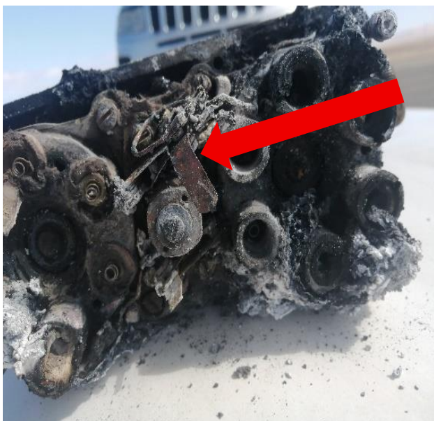
Fotografías 5 y 6: Inspección al magneto dual.
