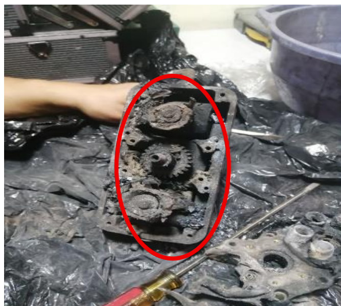
Fotografías 5 y 6: Inspección al magneto dual.
