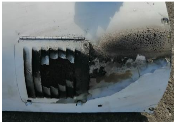
Fotografías 3 y 4: Daños en la capota superior y en el magneto tipo dual.
