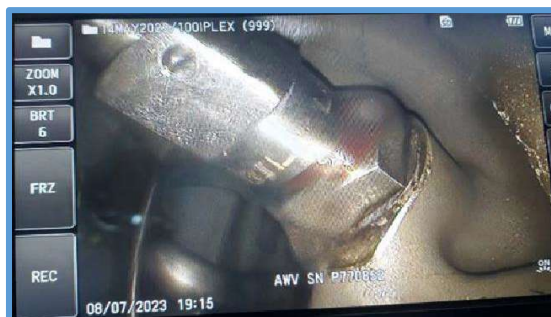
Fotografía N° 4: Vista lateral del niple de conexión (Tube Boss Nipple) de la cañería de suministro de aceite a la caja de engranaje principal con evidencia de filtración.
