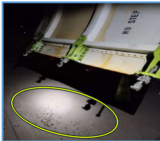
Fotografía N° 2: Evidencia de filtración de aceite en motor N° 1.
