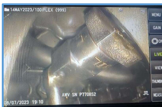
Fotografía N° 5: Vista lateral izquierda del niple de conexión (Tube Boss Nipple) de la cañería de suministro de aceite a la caja de engranaje principal con evidencia de filtración.
