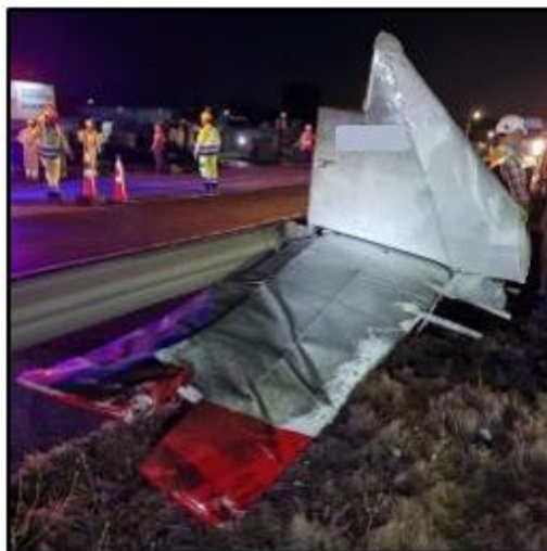
Fotografías N° 17 y 18: Empenaje y timón de dirección.
