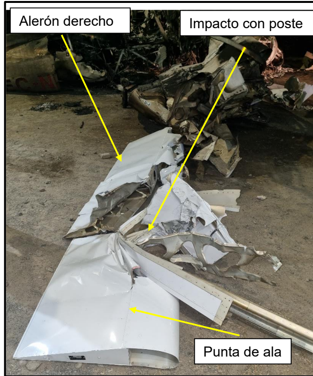
Fotografías N° 24, 25 y 26: Partes del ala derecha recuperadas.
