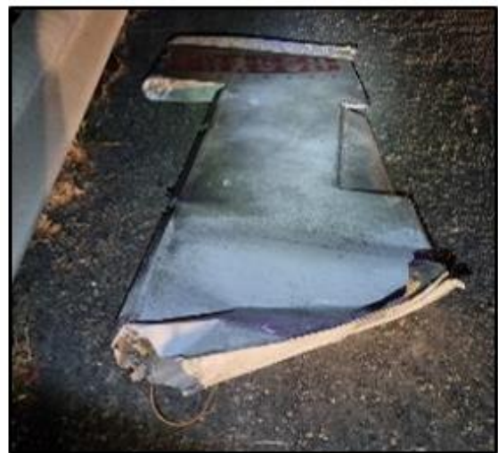
Fotografías N° 17 y 18: Empenaje y timón de dirección.
