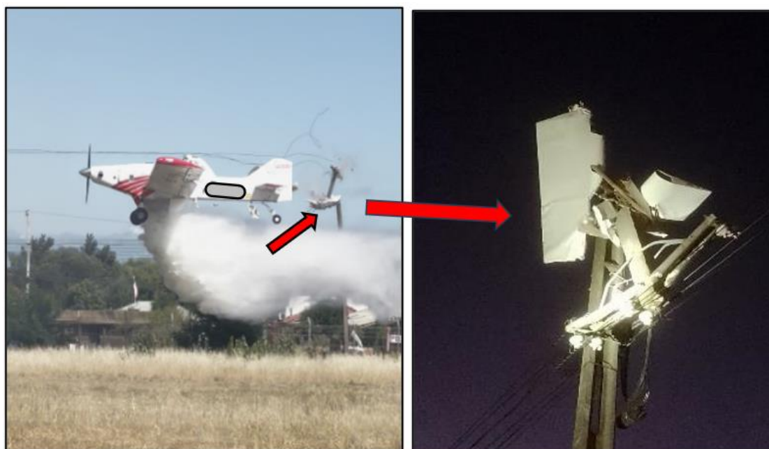
Fotografías N° 3 y 4: Impacto contra el poste del tendido eléctrico y alerón desprendido.
