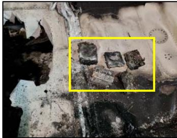
Fotografía N° 16: Equipos electrónicos de la aeronave destruidos.
