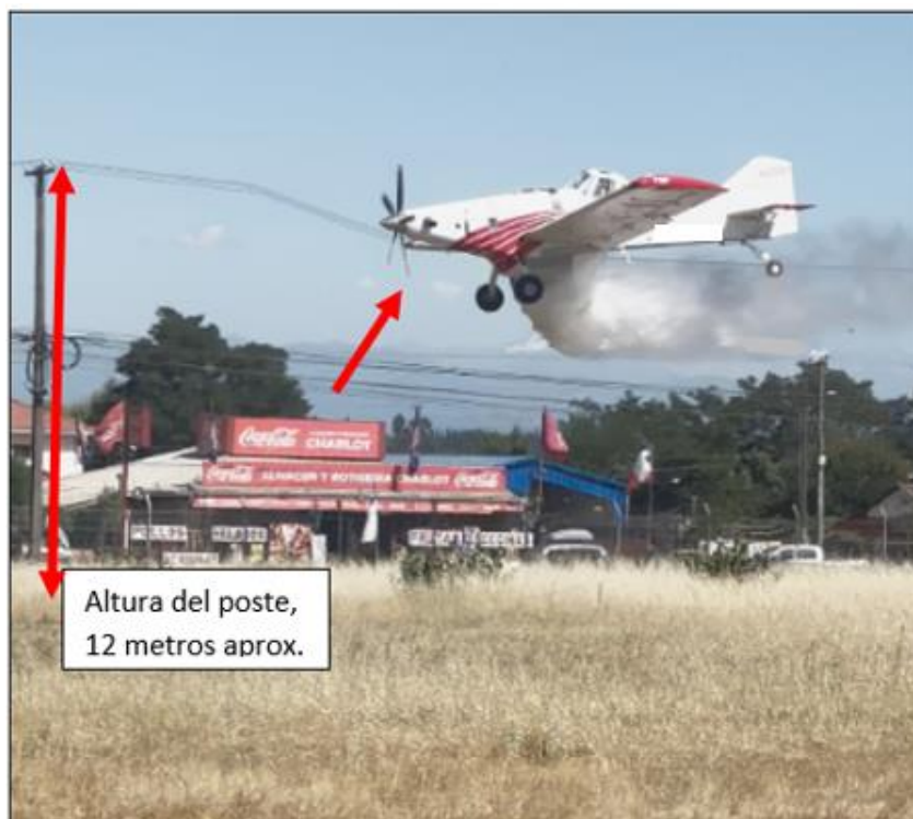
Fotografía N° 2: Ala derecha impactando contra el tendido eléctrico.
