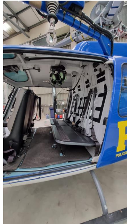
Fotografías N°2 y 3: Vista, referencial, de una aeronave AS-350 equipada con y sin cojines de asientos de los pasajeros (4 plazas).
