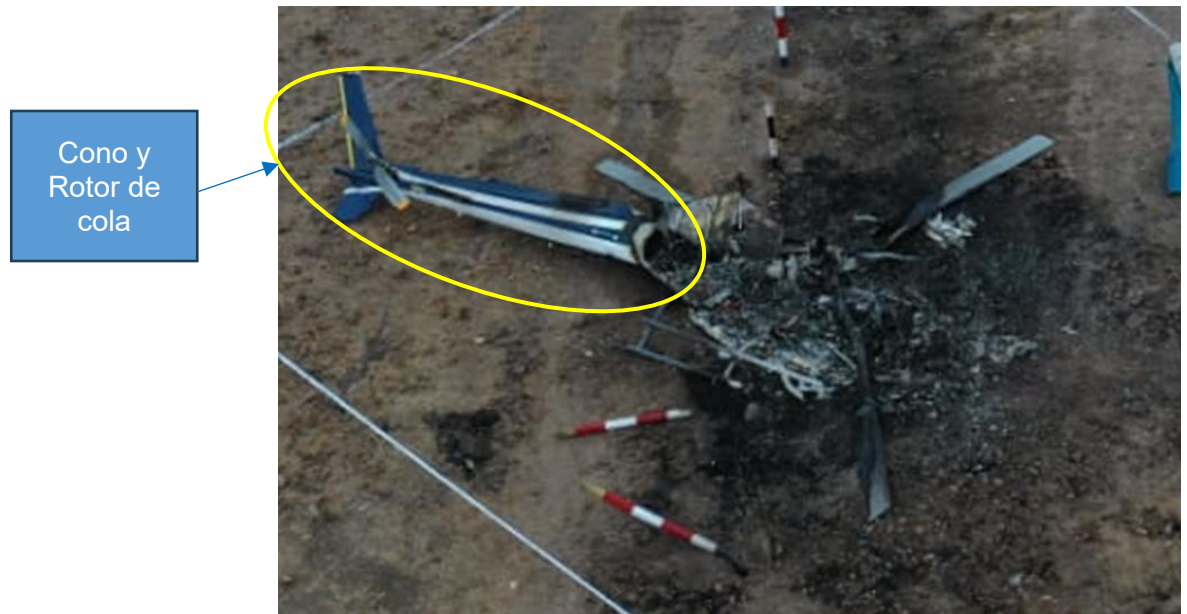
Fotografía N°11: Vista de los restos de la aeronave post incendio.
