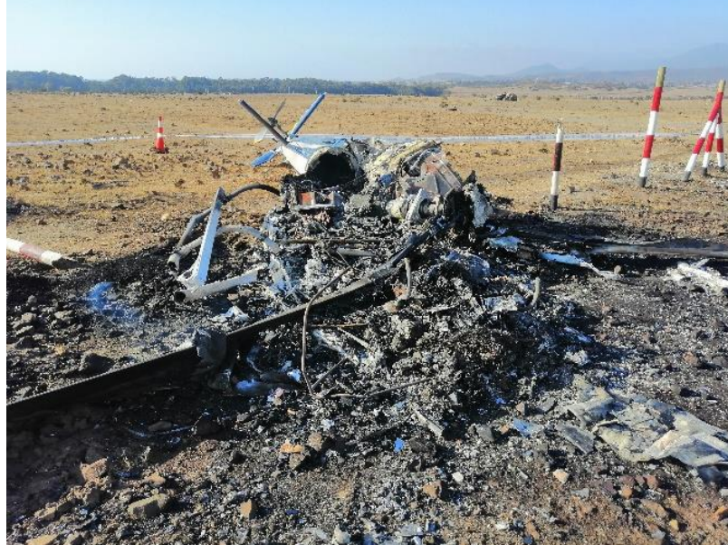
Fotografías N°12 y 13: Vista de los restos calcinados de la sección central y cabina de la aeronave.
