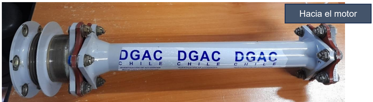
Fotografía N°32: Vista de un eje referencial del MGB/Engine Coupling Shaft.
