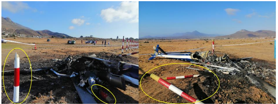
Fotografías N°8 y 9: Vista de Norte a Sur y de Sur a Norte, con restos de los polines impactados por la aeronave.
