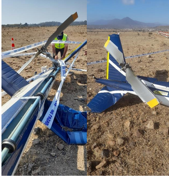
Fotografías N°17 y 18: Vistas del estabilizador horizontal lado izquierdo, rotor de cola y estabilizador vertical inferior.
