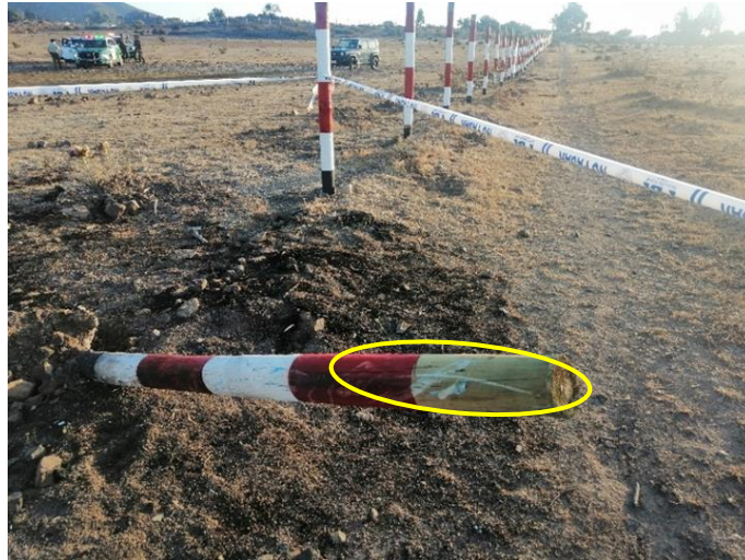
Fotografía N°10: Vista de las huellas de color celeste, dejadas por la pintura del helicóptero al momento de impactar la aeronave contra el polín de madera (círculo amarillo).
