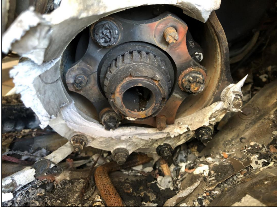
Fotografía N°30: Vista del Engine Shaft Flange/Coupling, lugar de conexión del MGB/Engine Coupling Shaft al motor.
