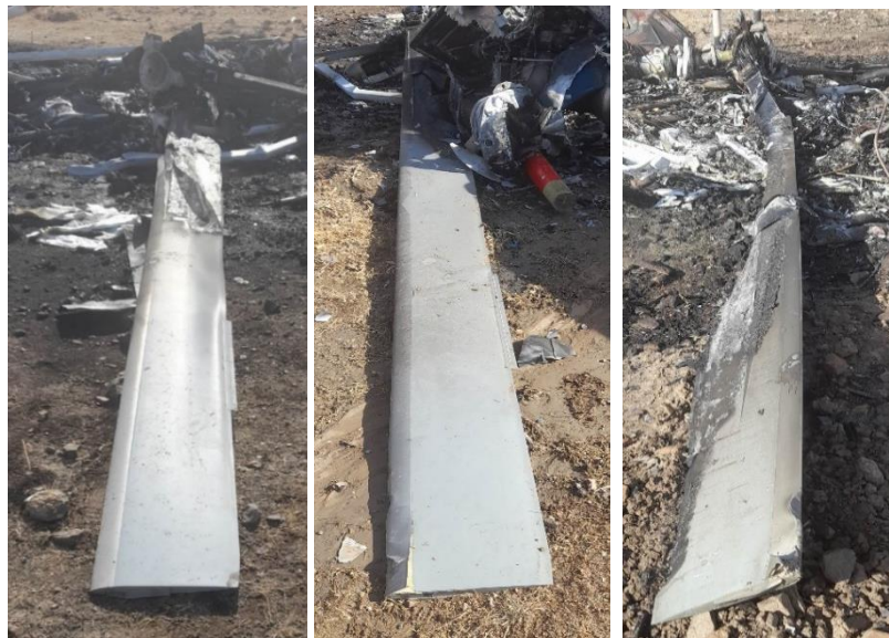
Fotografías N°14, 15 y 16: Vistas de las palas del rotor principal.
