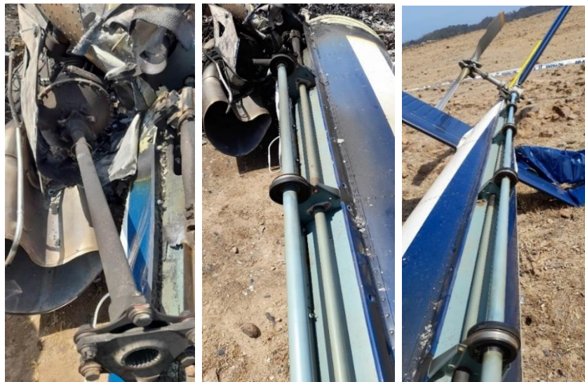
Fotografías N°19, 20 y 21: Vistas del eje de mando al rotor de cola.
