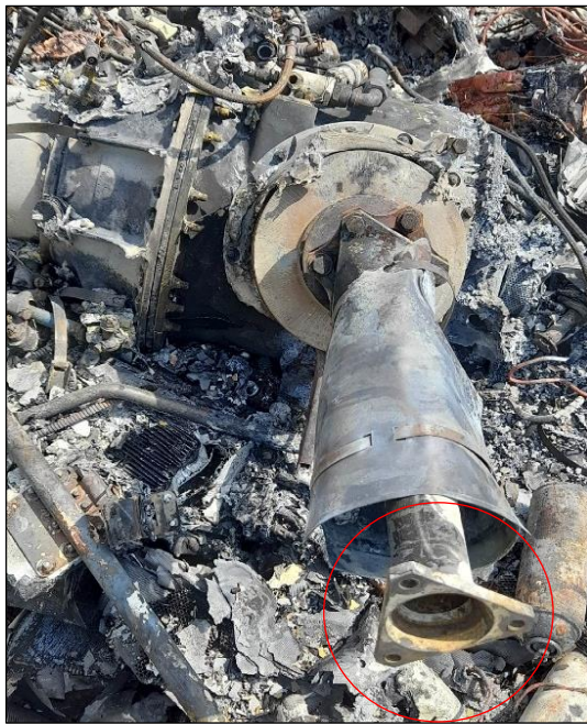
Fotografías N°27, 28 y 29: Vistas del MGB/Engine Coupling Shaft en el sitio del suceso (círculo rojo).
