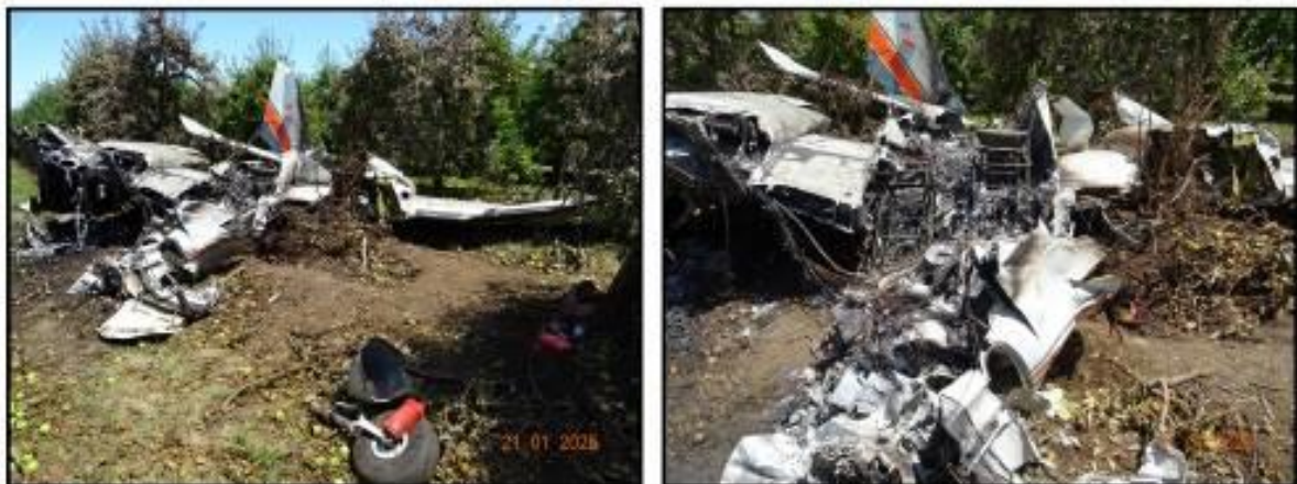
Imágenes N°3 y 4: Vista de los daños de la aeronave
