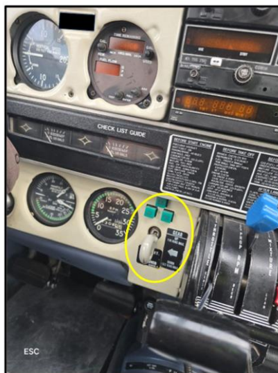
Imagen N°5: Palanca accionadora del tren de aterrizaje
