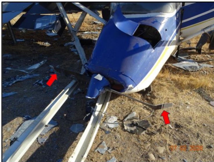
Imagen N°7: Daños en la hélice
