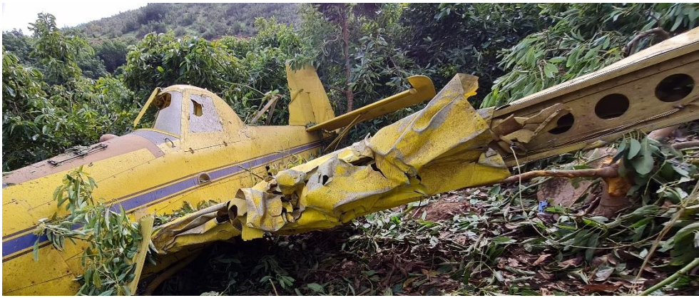
Fotografía 1: Daños ala izquierda
