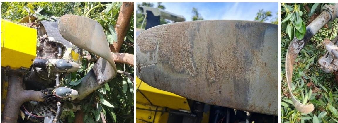
Fotografía 3: Ambas palas de la hélice deformadas
