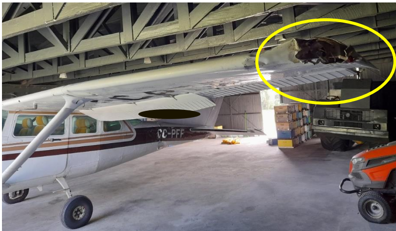
Fotografía N° 7: Vista del daño del ala izquierda.
