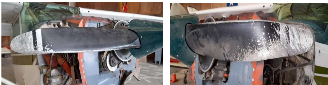
Fotografías 8 y 9: Vista de ambas palas dobladas.
