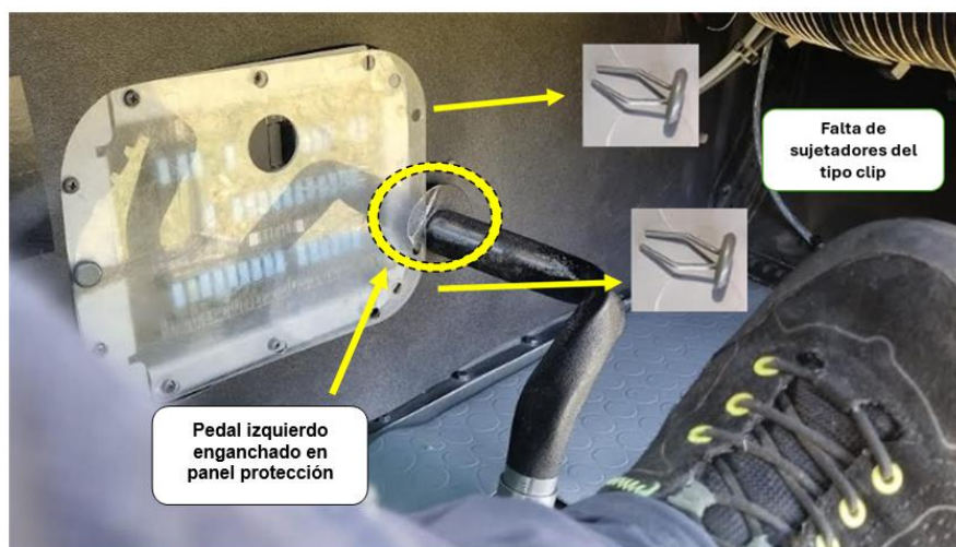
Fotografía N°8: Recreación de la obstrucción de recorrido del pedal izquierdo, al fijarse con la tapa de protección de los disyuntores.
