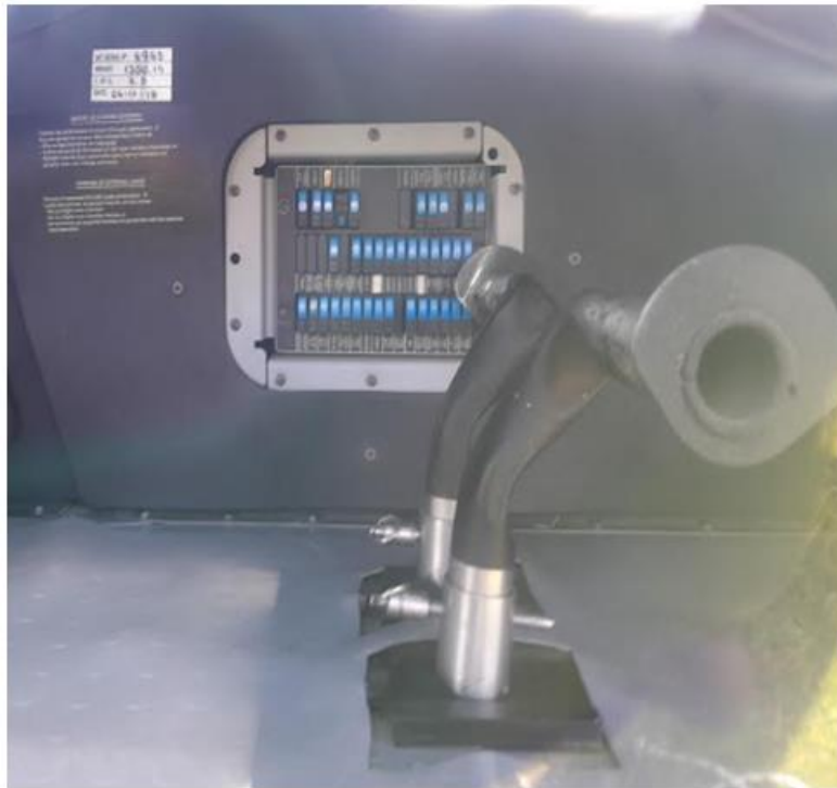
Fotografía N°5: Pedales de la aeronave con panel de disyuntores.
