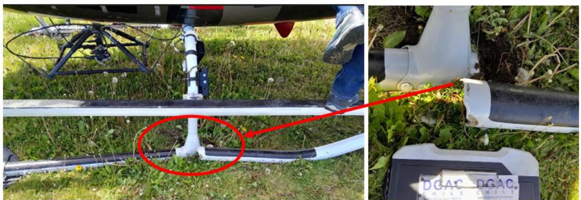
Fotografía N°12 y 13: Fractura del patín derecho del tren de aterrizaje.
