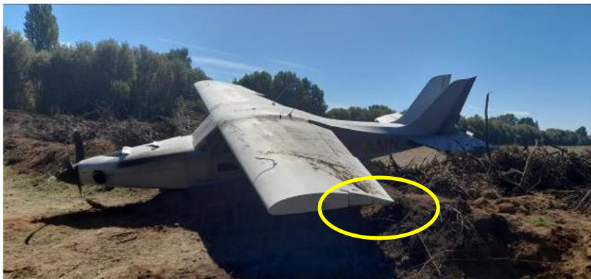
Fotografía N°1: Fractura del estanque alar de combustible
