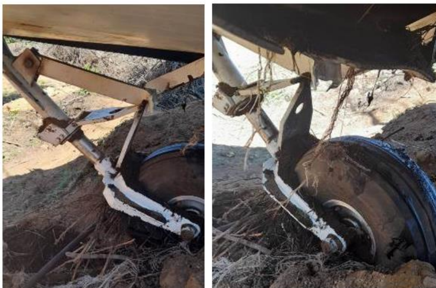
Fotografía N°5: Tren de aterrizaje de nariz con deformación.
