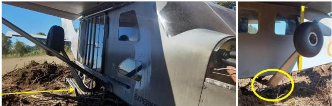
Fotografía N°4: Tren principal con deformación y torción de las piernas.
