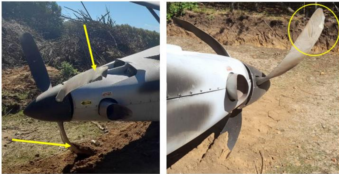
Fotografía N°3: Hélices con torción y pérdida de material.
