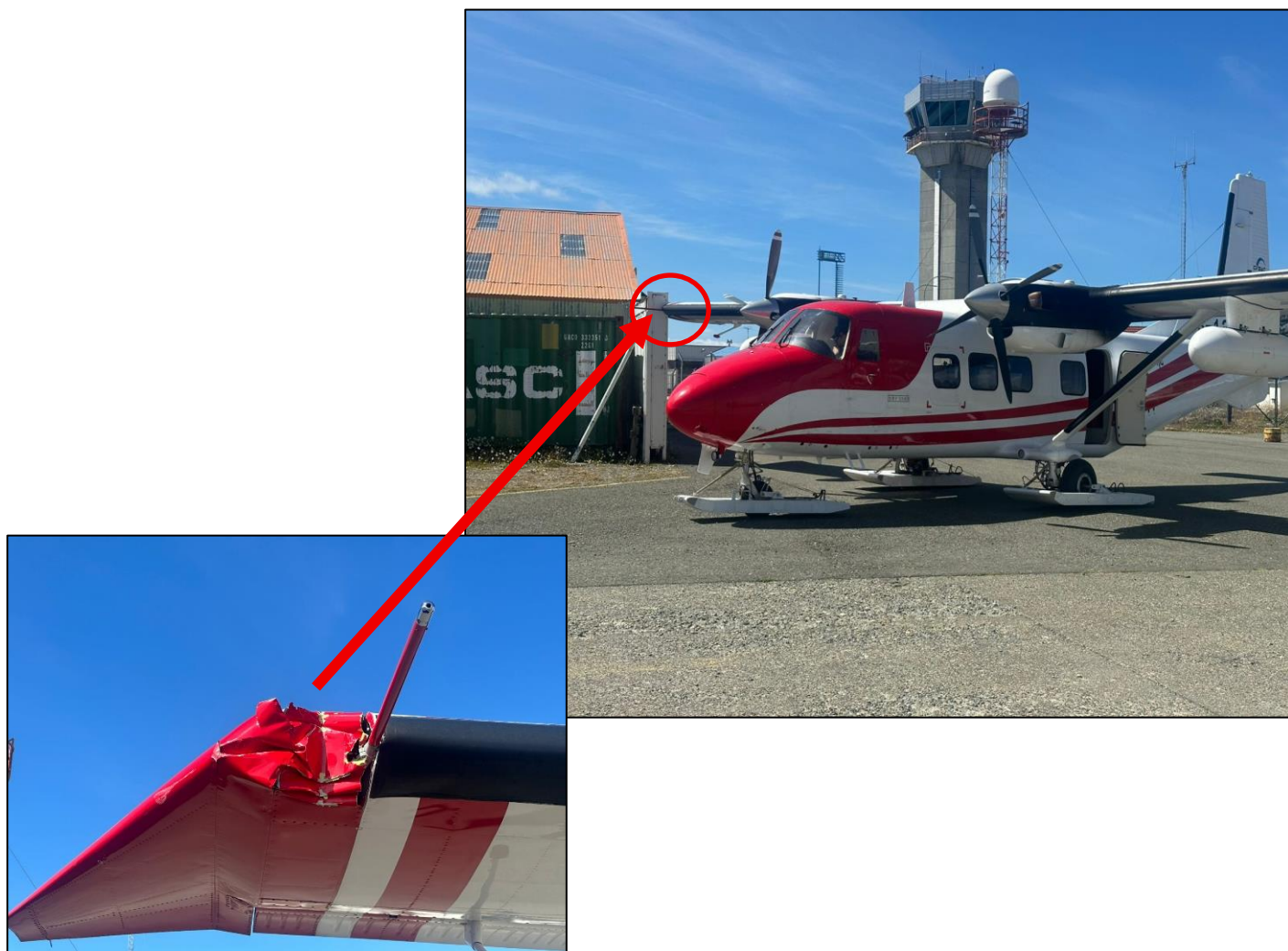
Fotografías 1 y 2: Aeronave del suceso e impacto del ala derecha
