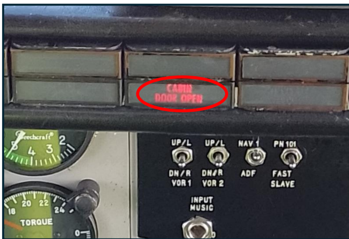
Fotografías N° 5 y 6: Sistema de indicación de puerta (Luz encendida y apagada)
