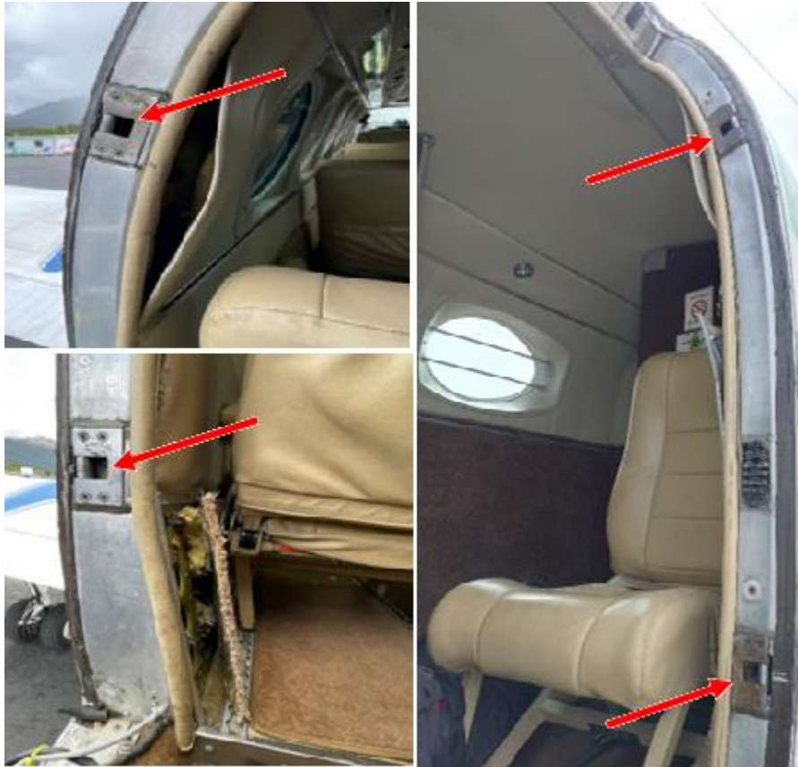
Fotografía N° 3: Puntos de aseguramiento en el marco de la puerta principal.
