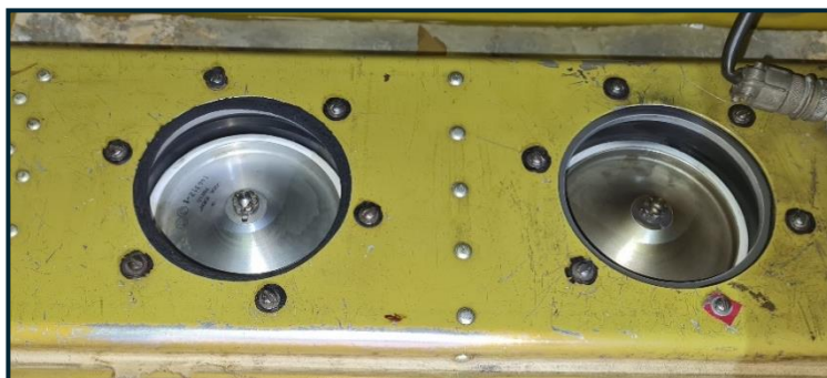
Fotografía N° 7: Válvulas de presurización.
