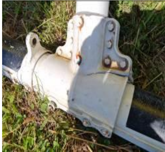
Fotografías N° 3 y 4: tubos cruzados deformados
