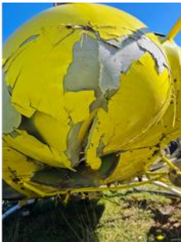
Fotografías N° 5 y 6: Nariz de la aeronave presentaba fracturas y deformaciones en la parte inferior
