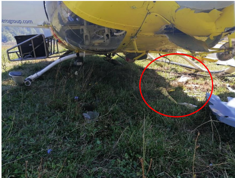
Fotografías N° 7: Cortacable inferior de la aeronave se encontró desprendido.
