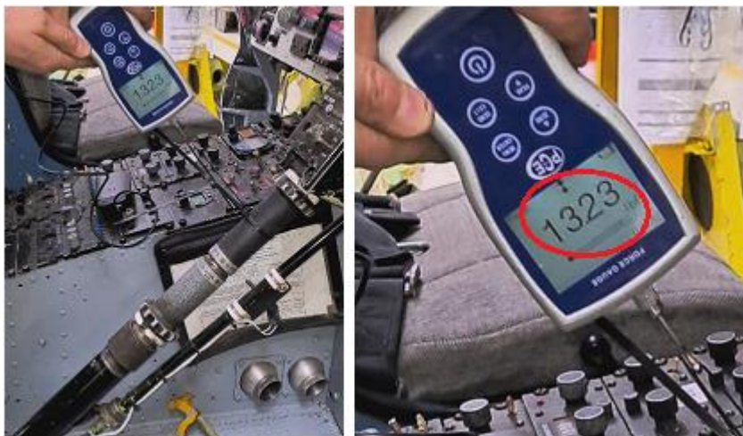
Fotografía N° 16: Fricción del bastón de mando colectivo
