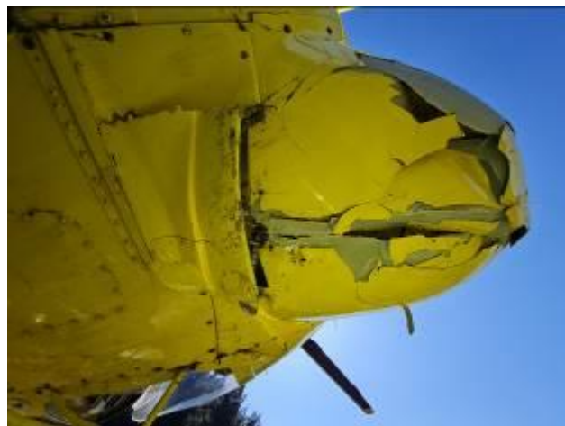
Fotografías N° 5 y 6: Nariz de la aeronave presentaba fracturas y deformaciones en la parte inferior
