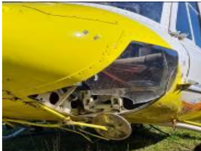
Fotografía N° 2: Daños espejos del helicóptero
