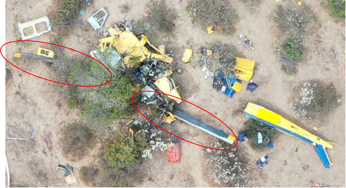
Fotografía N° 17: Vista superior, que muestra la posición de las palas del rotor principal (marcas rojas).
