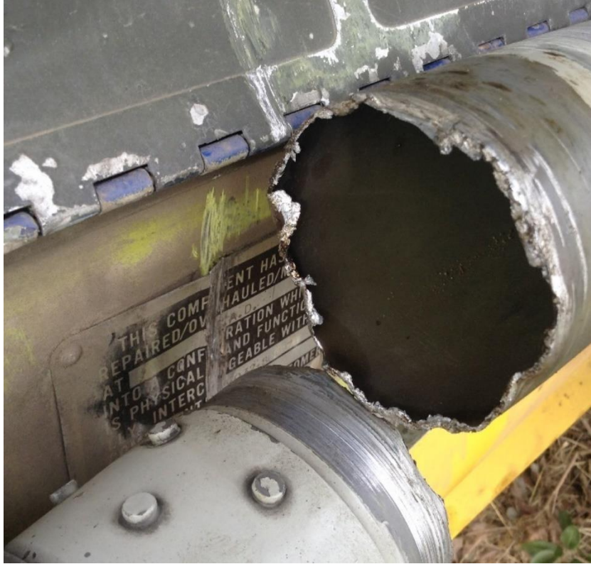
Fotografía N° 28: Vista de la fractura con deformación del eje de transmisión al rotor de cola.
