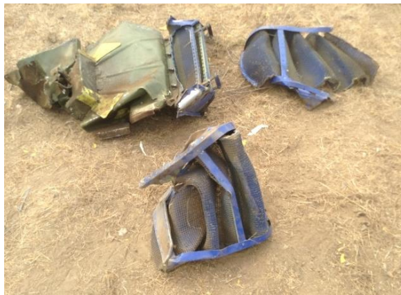
Fotografía N° 30: Estructura de filtros de malla del motor.
