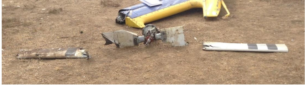
Fotografía N° 15: Rotor de cola con palas fracturadas.
