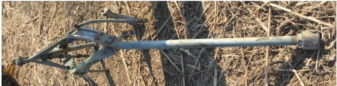
Fotografía N° 18: Vista de la barra estabilizadora del rotor principal.
