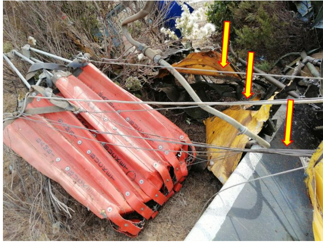
Fotografía N° 24: Vista de las líneas de suspensión y trip Line del Bambi Bucket, en tensión (flechas amarillas).
