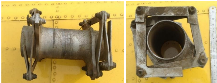
Fotografías N° 32 y 33: vistas del eje de transmisión entre motor y caja de engranajes principal.
