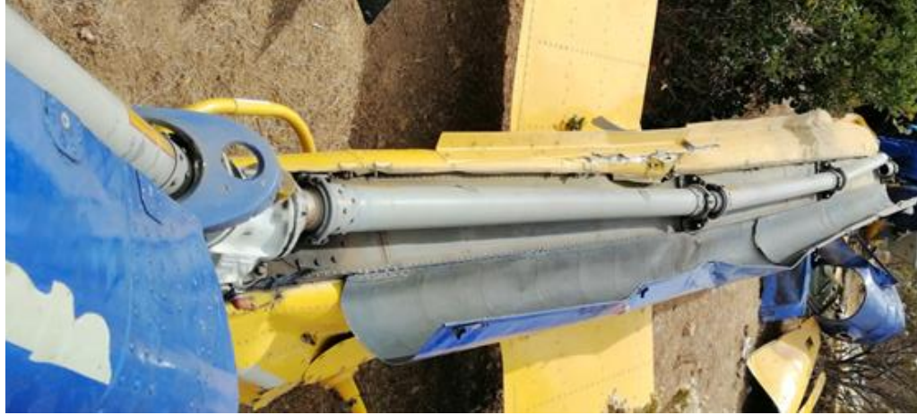
Fotografía N° 29: Vista del eje de transmisión al rotor de cola.
