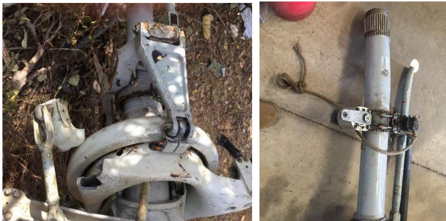
Fotografías N° 36 y 37: Vista de plato azimutal y mástil, fracturados y deformados.
