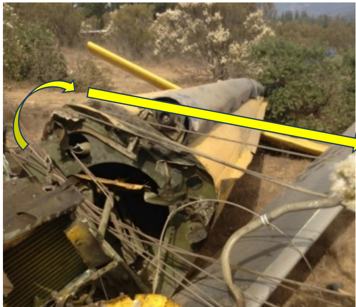
Fotografía N° 21: Líneas de suspensión del Bambi Bucket, en la zona de unión fuselaje con el cono de cola.
