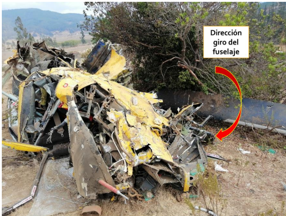
Fotografía N° 16: Vista del fuselaje, invertido.
