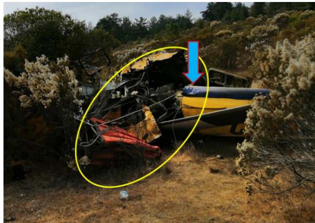
Fotografía N° 25: Puntos de apoyo en el carenado del eje de transmisión en el cono de cola (flecha azul) de las líneas de sujeción del Bambi Bucket.
