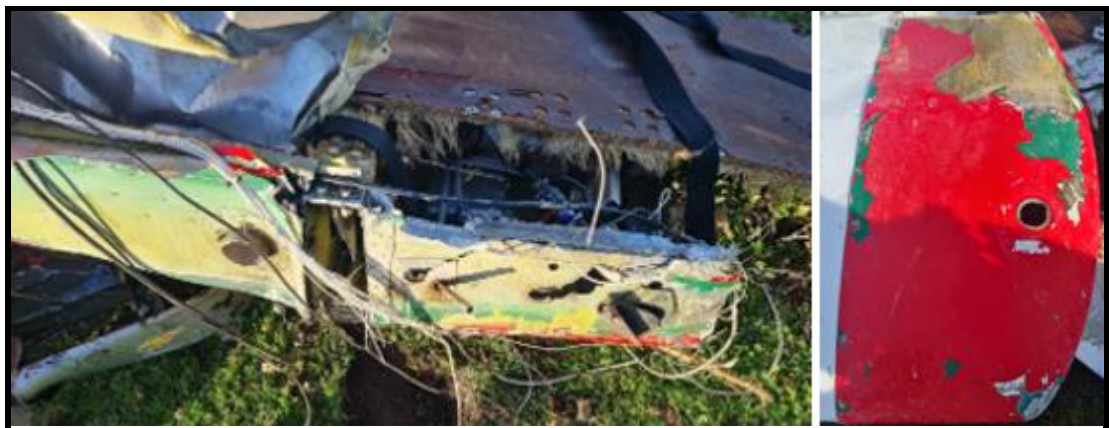
Fotografía N°18: Zona de amarre ala izquierda y estanque punta de ala.
