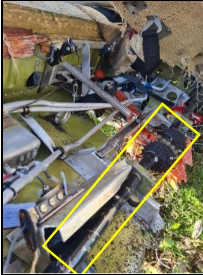
Fotografía N°29: Sistema de accionamiento de flaps.
