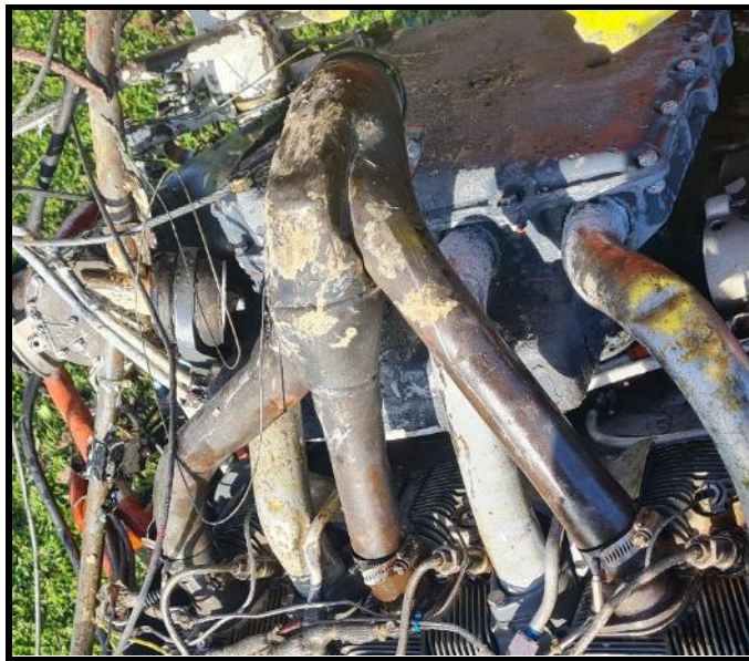
Fotografía N°43: Ductos de escape.
