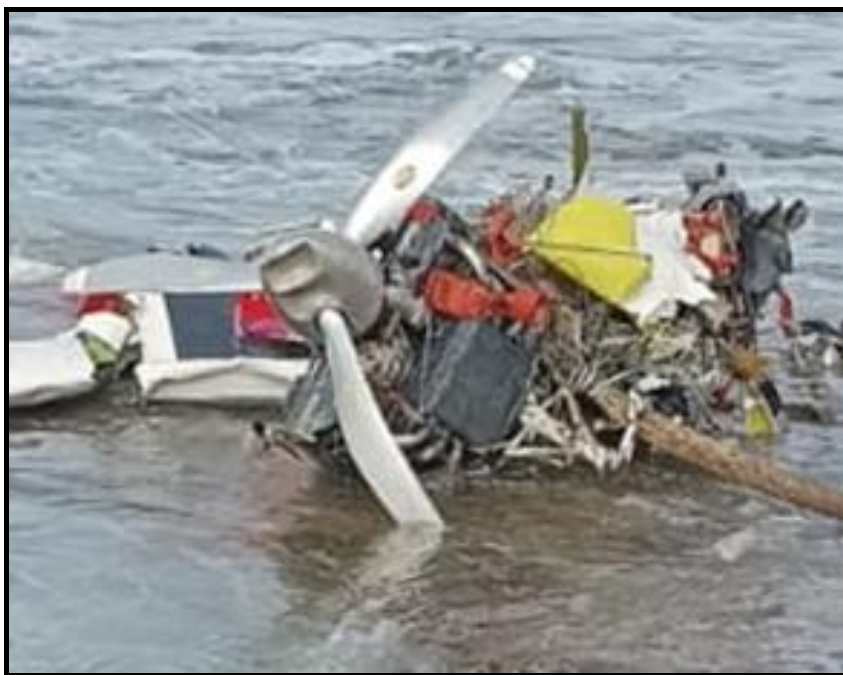
Fotografía N°50: Vista de la hélice y sus palas, al momento de ser extraída del mar.
