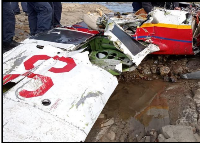
Fotografía N°17: Parte del ala derecha.
