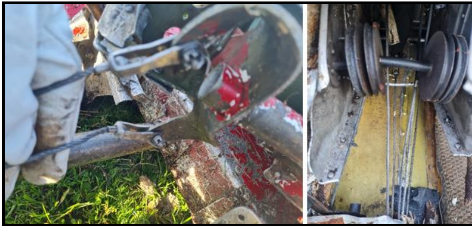
Fotografías N°22 y 23: Vista de los cables de control timón de dirección.
