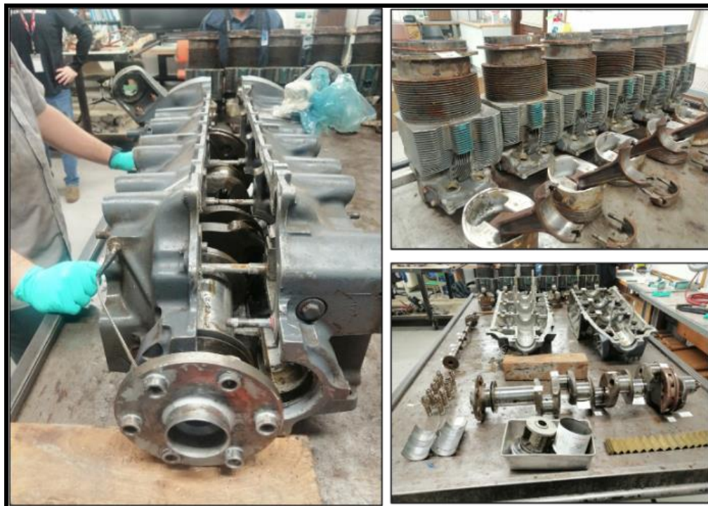
Fotografías N°47, 48 y 49: Vista del motor durante su desarme.
