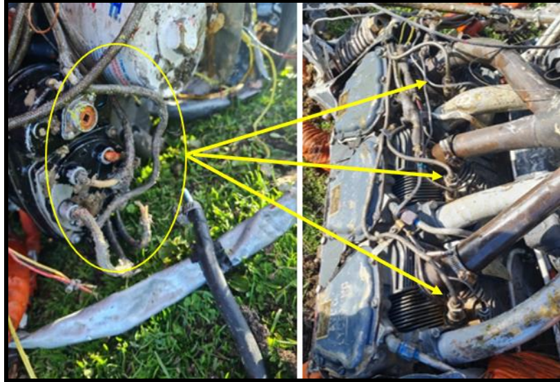
Fotografías N°41 y 42: Sistema de encendido del motor.
