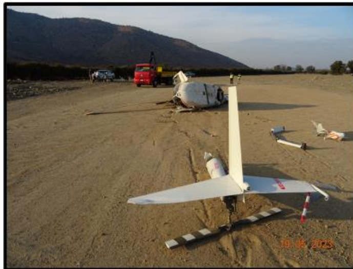
Imagen N°7: Desprendimiento del cono de cola.
