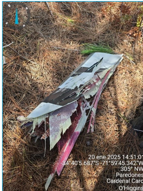
Fotografía N°19: Vista de la mitad de la pala del rotor de cola.
