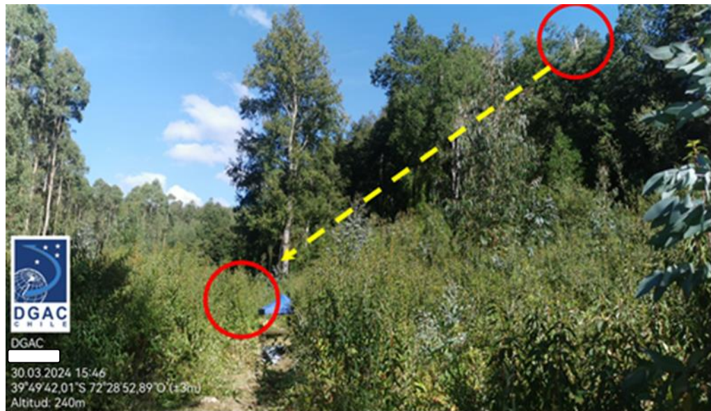
Imagen 7: Ubicado el lugar de los árboles que fueron impactados, se puede determinar que estaban en la trayectoria de salida de la aeronave, ubicados en una depresión del terreno hacia el Noreste.
