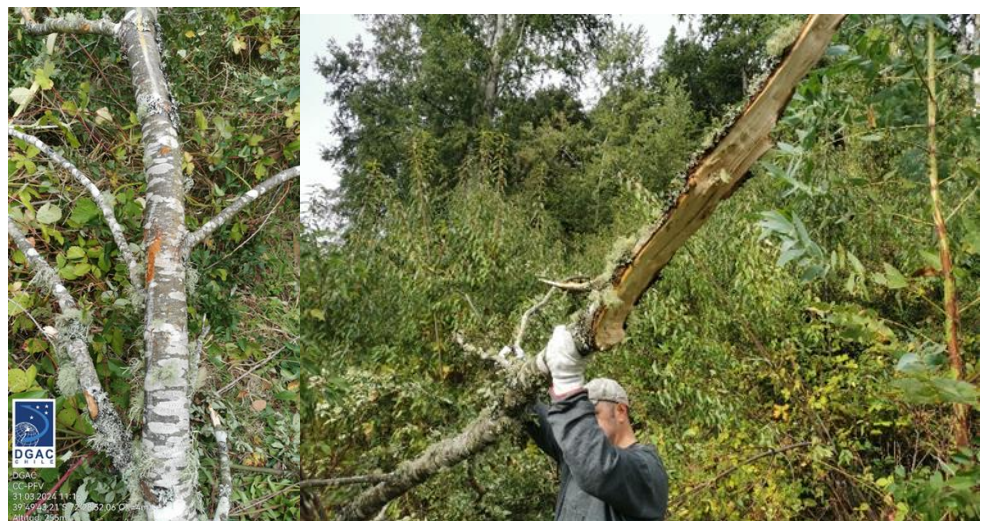
Imagen 6: Rama cortada de tamaño y forma del impacto en el ala izquierda, con presencia de pintura de la aeronave.
