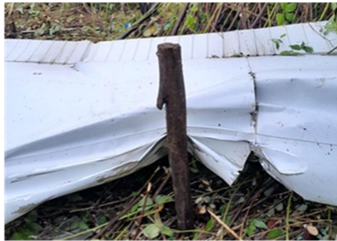
Imágenes 3, 4 y 5: Daño en el ala izquierda con dimensiones de los árboles rotos en la trayectoria de la aeronave.
