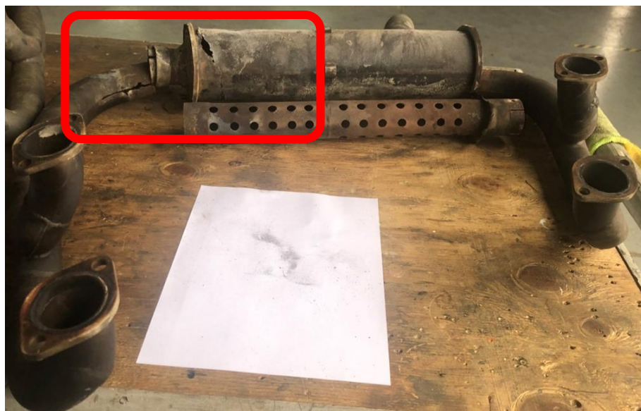
Imagen N°4: Desmontaje y visualización de los daños en el silenciador.
