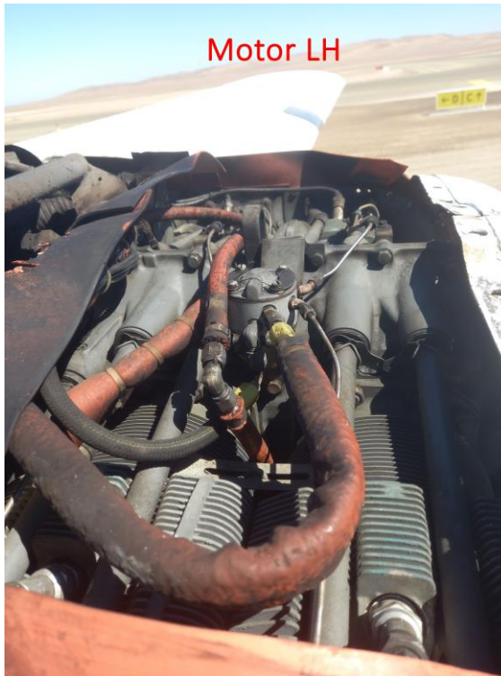
Imagen N° 3: Vista del área afectada por las llamas del motor izquierdo.
