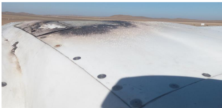
Imagen N° 2: Cubierta superior del motor izquierdo quemada.
