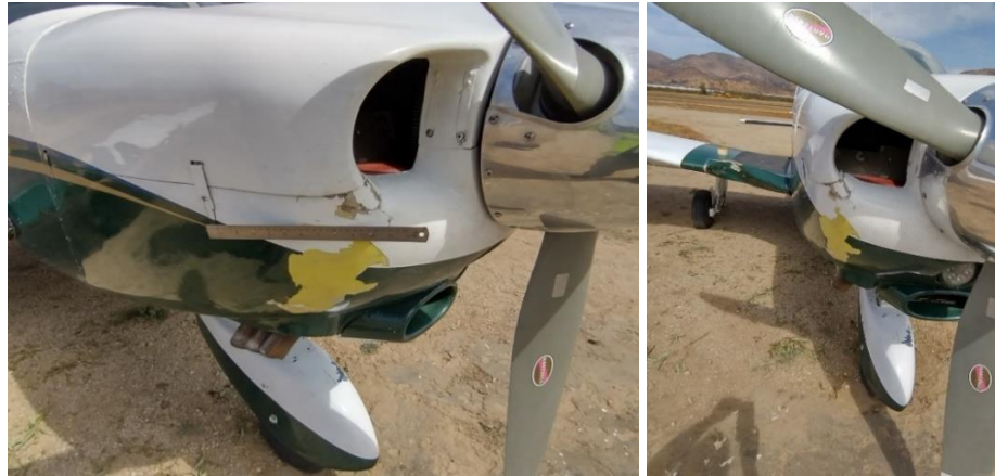
Fotografías N° 9 y 10: Daños estructurales en la capota inferior del motor.
