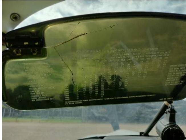
Fotografía N° 13: Parasol del lado del piloto al mando con fracturas.
