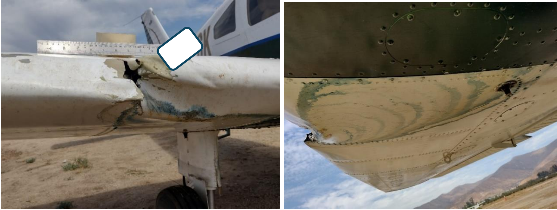
Fotografías N° 5 y 6: Daño estructural en el estanque de combustible del ala derecha y evidencia de derrame de combustible.
