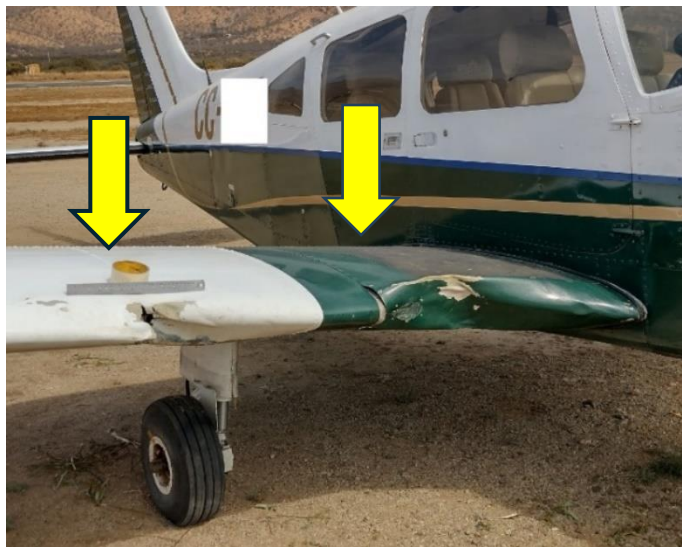
Fotografía N° 4: Vista de daños estructurales en el ala derecha.
