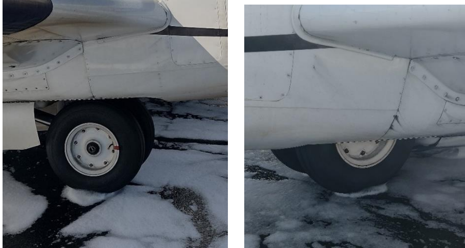
Fotografías N° 11 y 12: Recorridos de las piernas principales del tren de aterrizaje.
