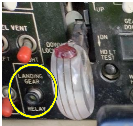
Fotografía N° 15: Posición de disyuntor LANDING GEAR RELAY.
