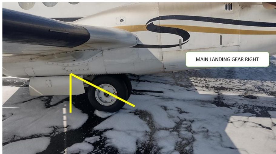
Fotografía N° 10: Ángulo de recorrido de la pierna principal derecha.
