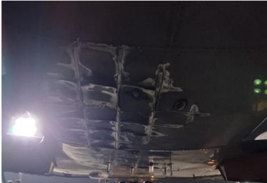
Fotografía N° 8: Daños, por arrastre, en el recubrimiento del fuselaje.
