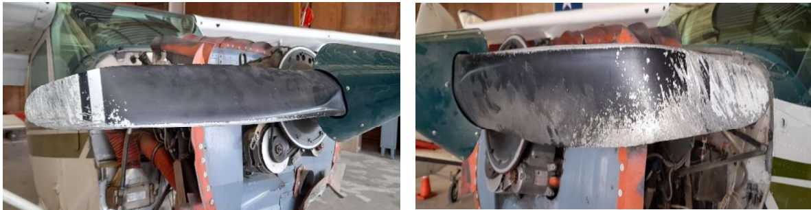
Fotografías 8 y 9: Vista de ambas palas dobladas.
