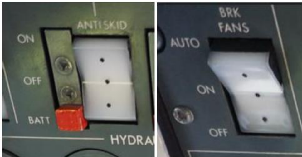
Fotografías N°13 y 14: Interruptores sistema antiskid.
