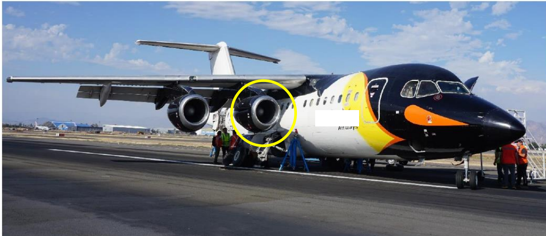
Fotografías N°5: Motor N°3, sin evidencia de daños visuales.
