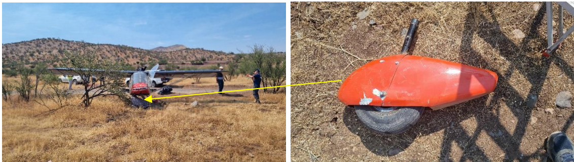
Fotografía N°4: Tren de nariz, fracturado.
