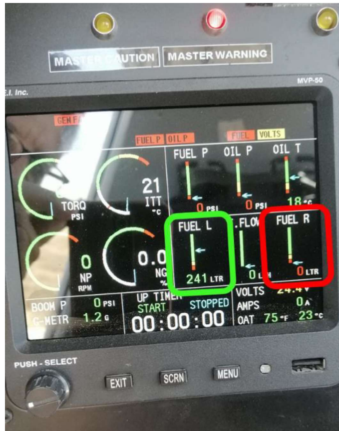
Fotografía N° 12: Vista de la indicación del estanque izquierdo (cuadro verde) y derecho (cuadro rojo), respectivamente, en la condición de la aeronave no nivelada.
