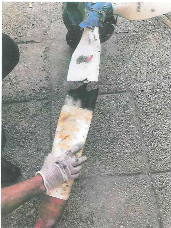
Imagen 3. Vista de la pala fracturada.
