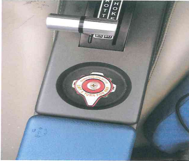
Fotografía N°3: Referencial Válvula de combustible
