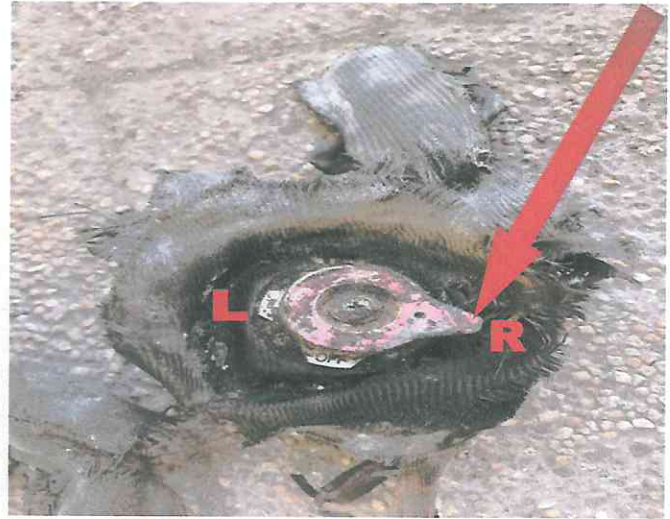
Fotografía N°4: Válvula de combustible en posición derecha (R).
