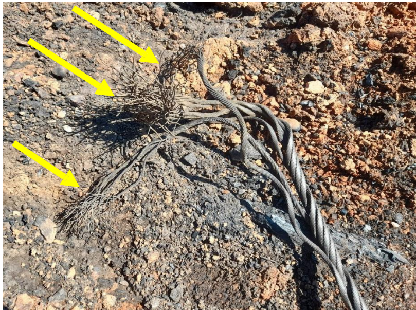
Fotografía N°7: Vista del estado del cable post impacto con la hélice de la aeronave.
