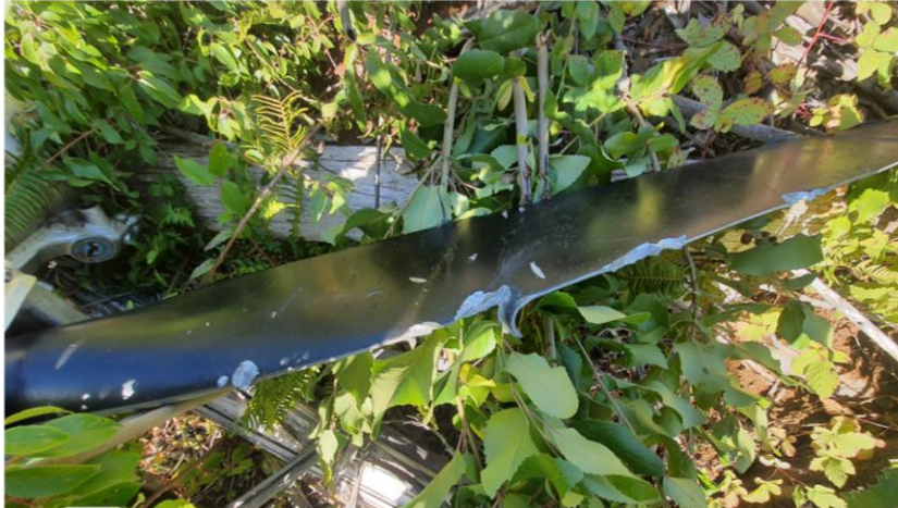
Fotografías N°8, 9 y 10: Muestran la hélice desprendida del avión
