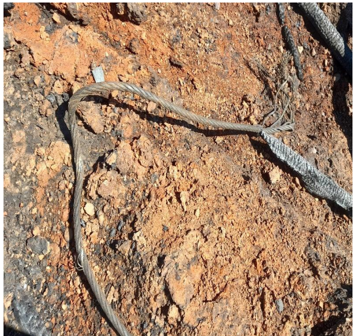
Fotografías N°5 y 6: Vistas del cable cortado, que impactó la aeronave.
