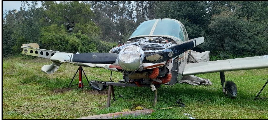
Fotografía N°10: Vista del avión nivelado en gatas.
