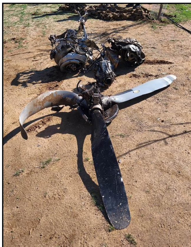
Fotografías N° 8 y 9: Restos de los motores y hélices.
