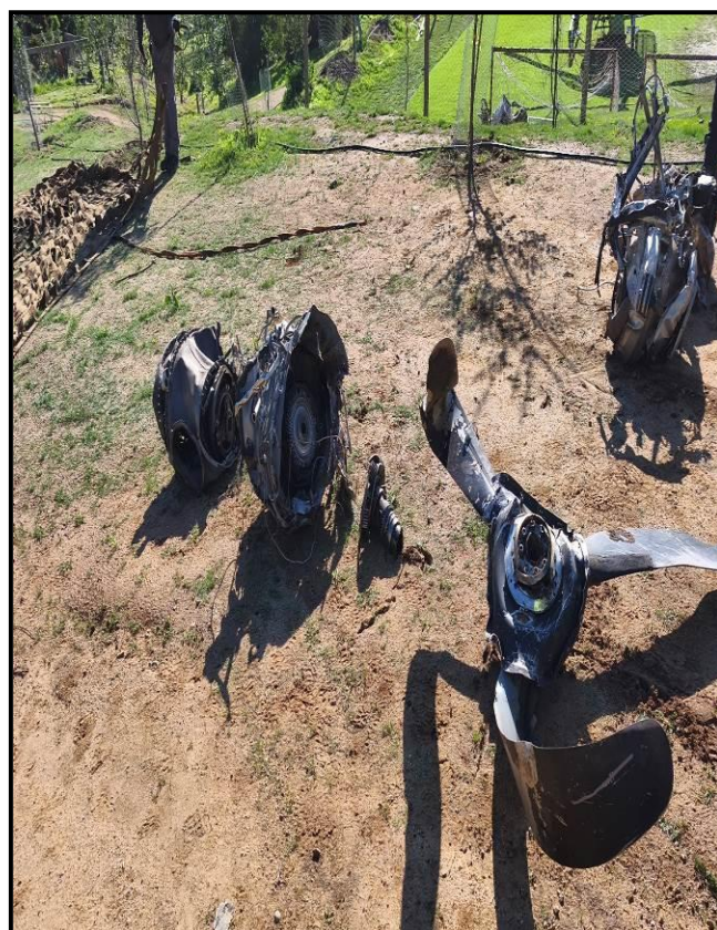
Fotografías N° 8 y 9: Restos de los motores y hélices.
