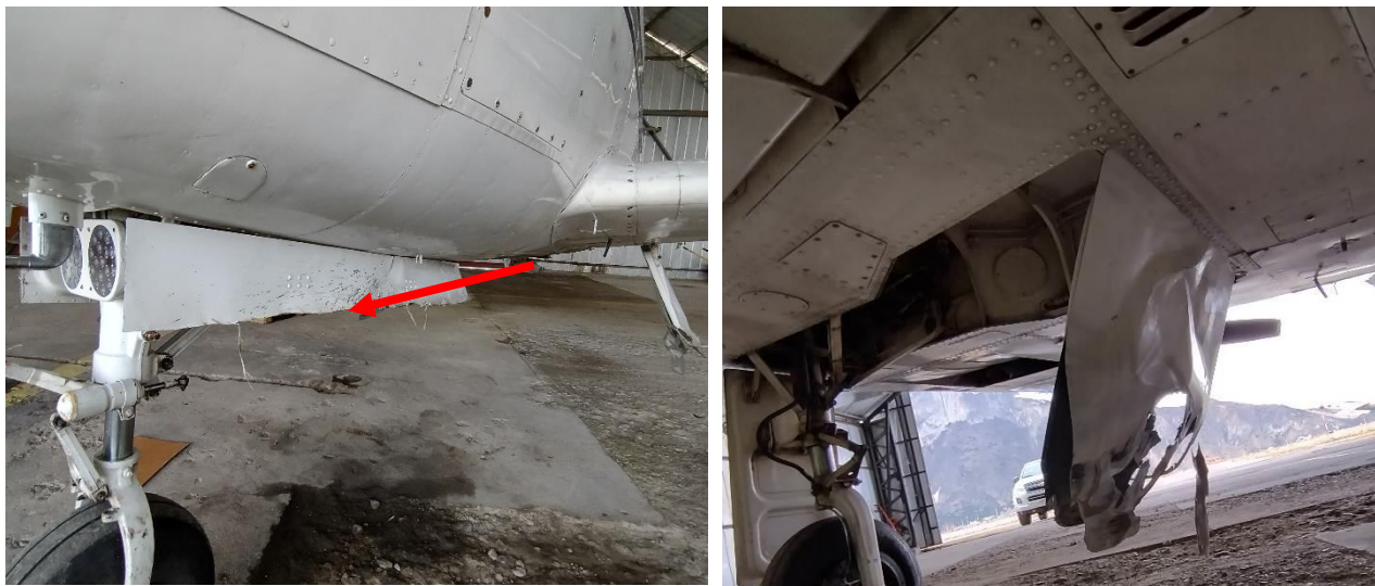
Fotografías N° 5 y 6: Portalones del tren de aterrizaje con daños
