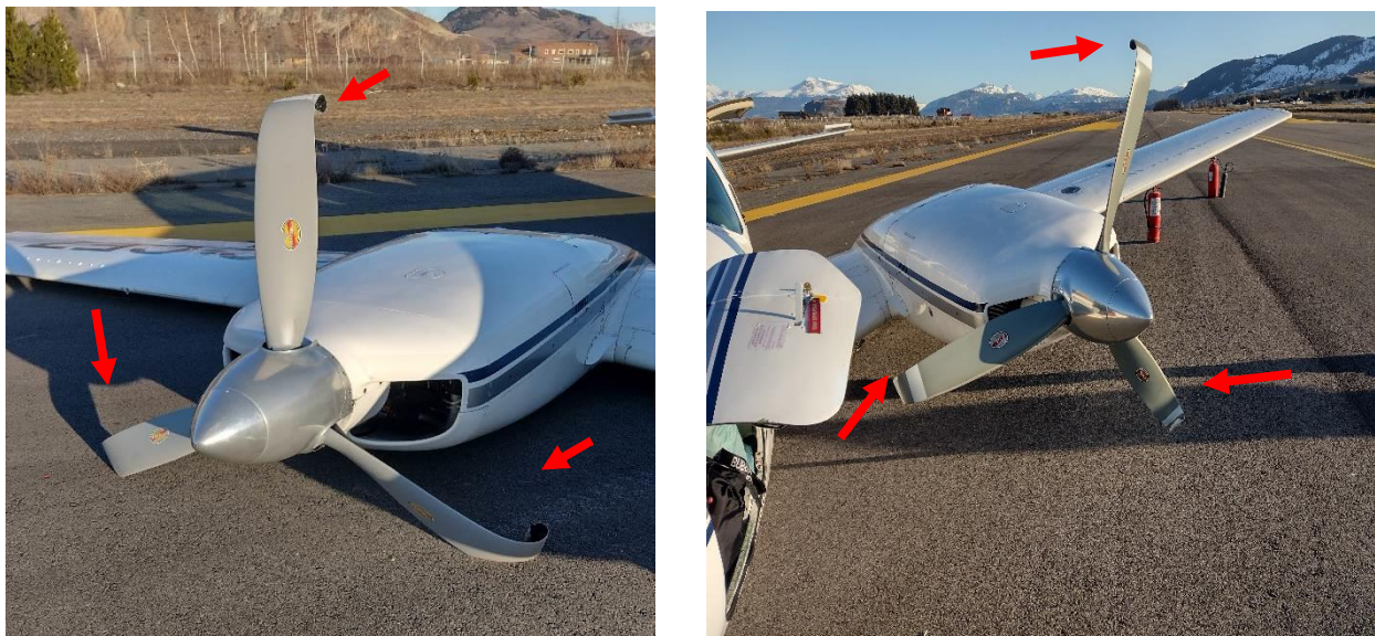
Fotografías N° 7 y 8: Hélices Motores N° 1 y 2 con daños
