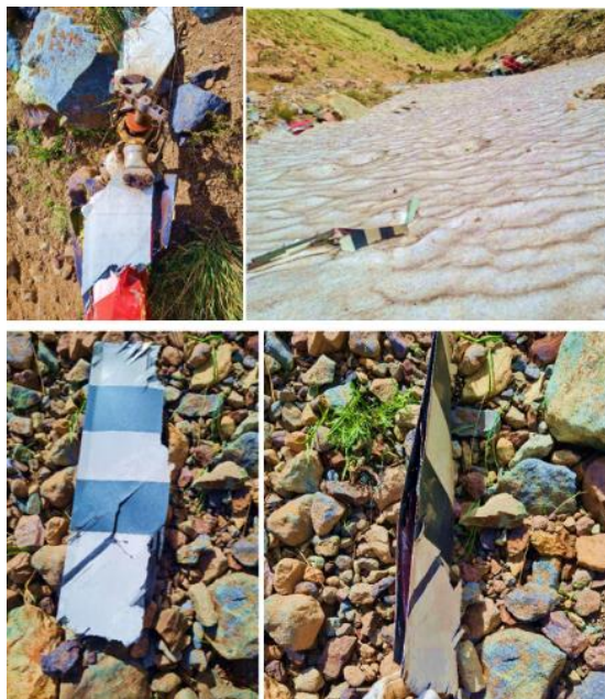
Fotografía N°16, 17 y 18: Rotor de cola.
