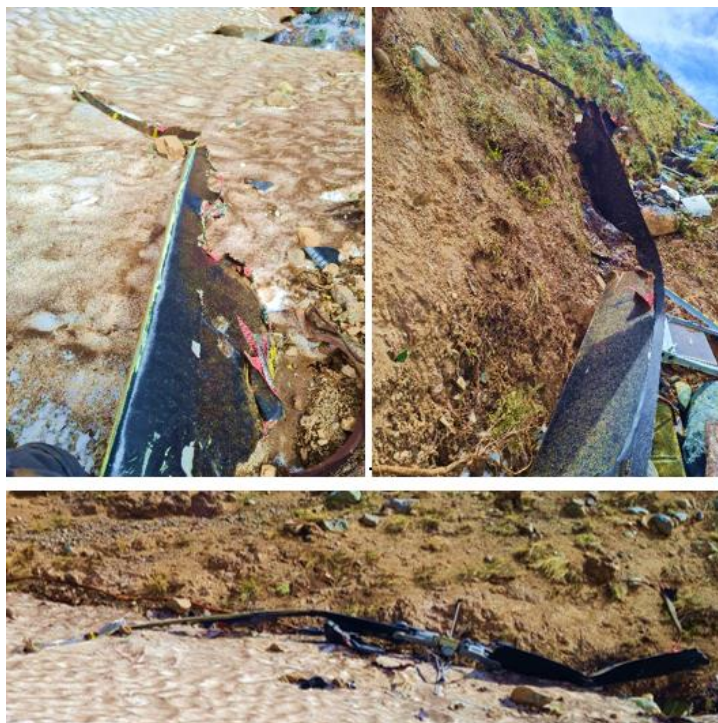
Fotografía N°11, 12 y 13: Rotor principal.
