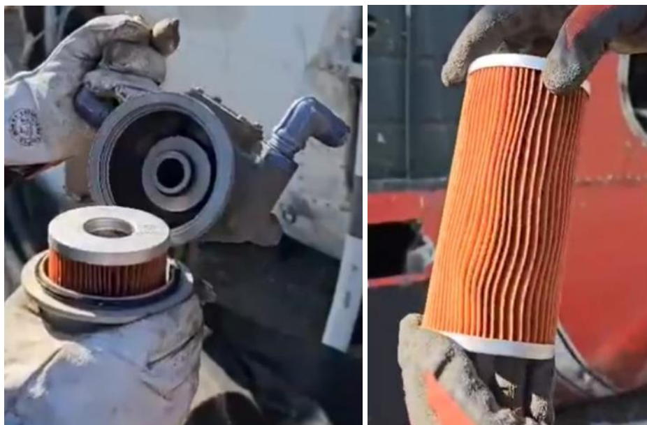
Fotografías N°37 y 38: Filtro de combustible.
