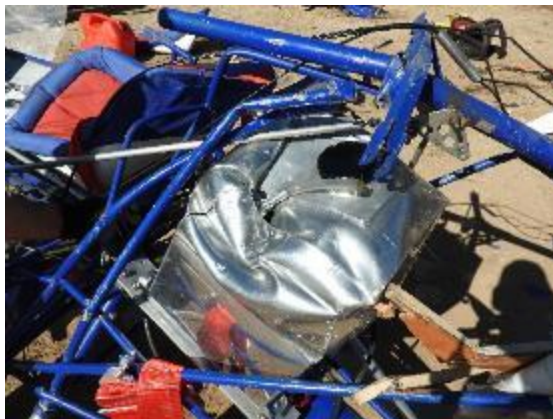
Fotografía N°16: Estanque de combustible de la aeronave.
