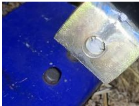
Fotografía N°3: Perno de soporte del montante del ala izquierda fracturado.
