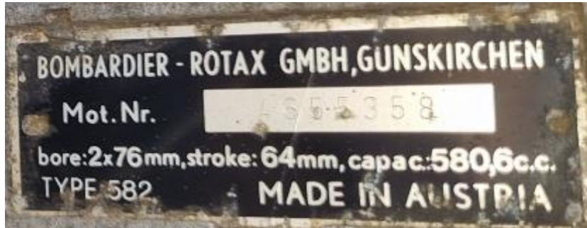
Fotografía N°15: placa de identificación del motor.
